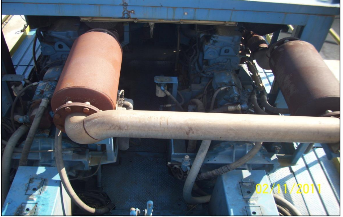
Şekil 4.6. Motor ve şanzuman (iki adet 540 HP, şanzuman ve tork konvertör).
