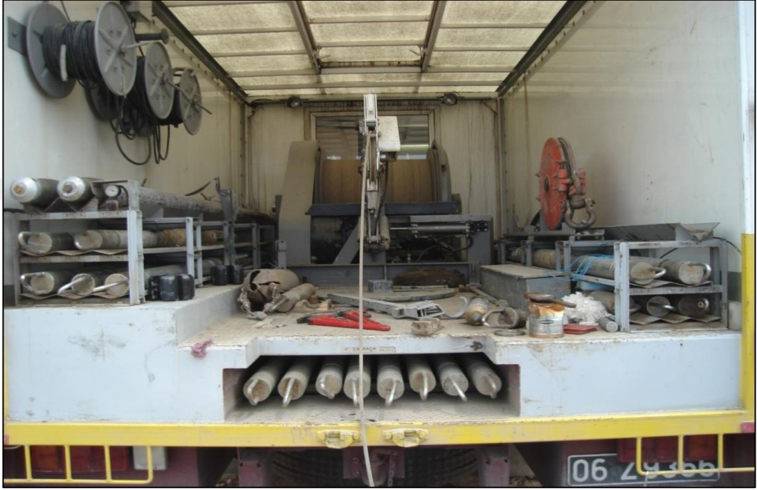
Şekil 4.11. Jeofizik kuyu içi log ekipmanları.
