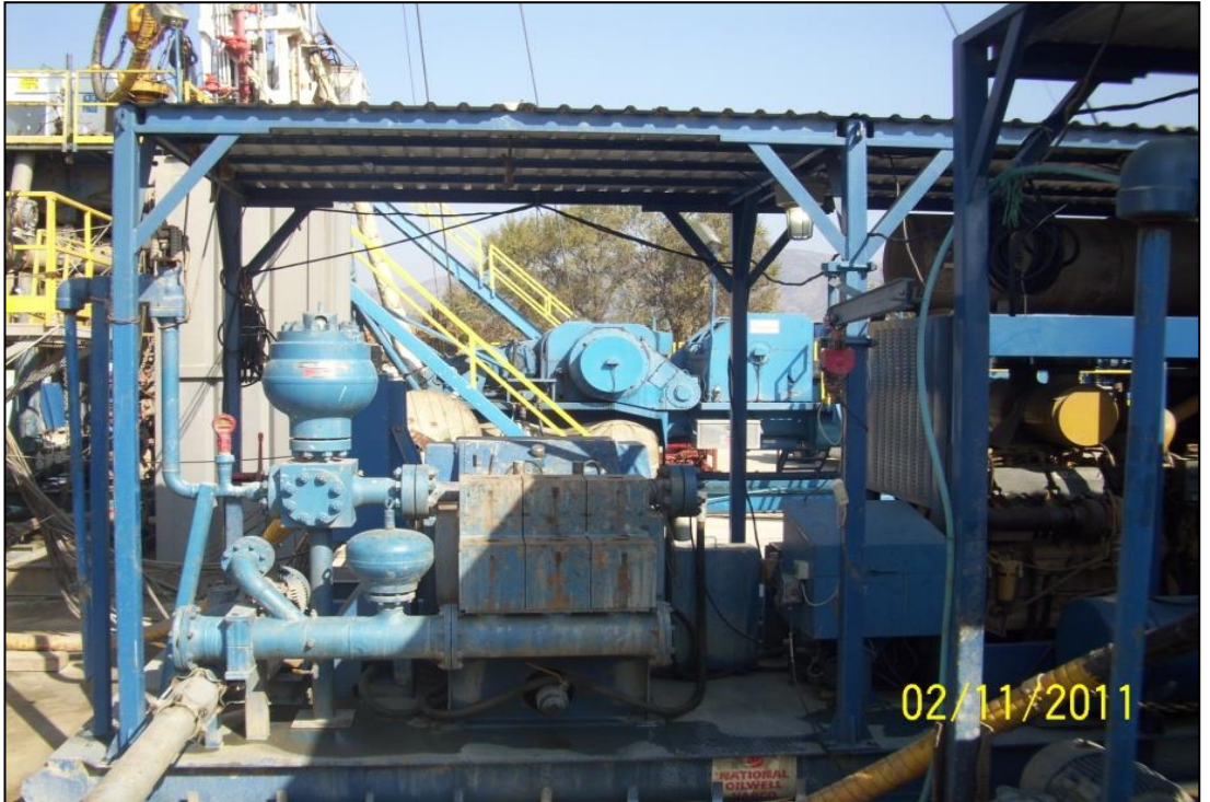
Şekil 4.7. Üçlü çamur pompası.
