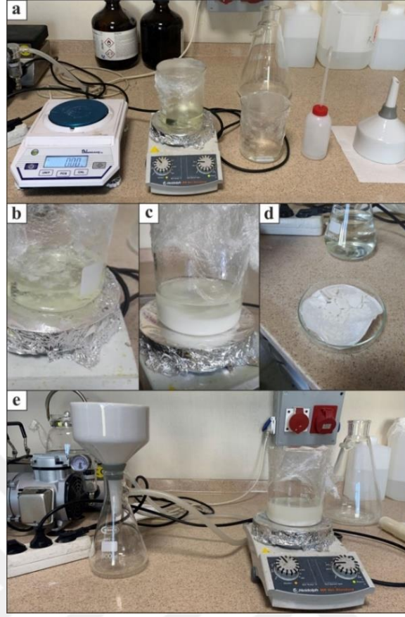
Resim 3.11 Ömer-Gecek bölgesi jeotermal akışkanı üzerinde gerçekleştirilen lityum karbonat kristalizasyon çalışmaları, (a) Kristalizasyon düzeneği, (b) Kristalizasyon başlangıcı, (c) Kristalizasyon sonu, (d) Süzölmüş lityum karbonat ve (e) Lityum karbonat süzme düzeneği.
