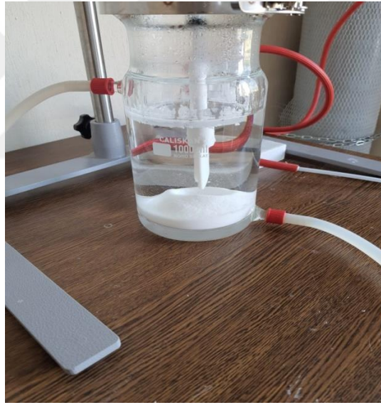
Resim 3.8 Yaşlandırma süresi bitiminde filtrasyon öncesi reaktörde çözelti içinde oluşan Li 2 CO 3 kristalleri.
