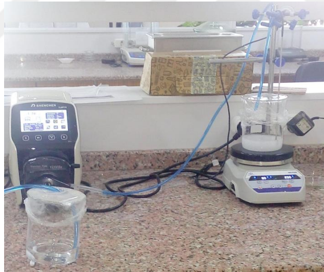
Resim 3.2 Peristaltik pompa ile beher içindeki ana çözeltiye \text{Na}_2\text{CO}_3 besleme işlemi.
