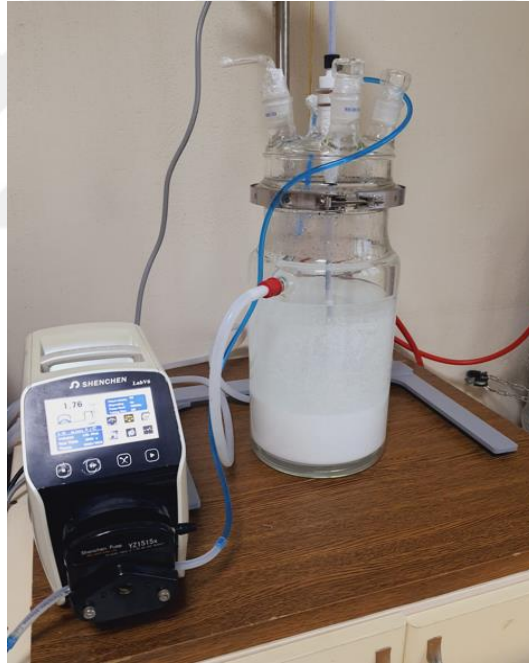
Resim 3.6 Peristaltik pompa ile reaktör içindeki ana çözeltiye \text{Na}_2\text{CO}_3 besleme işlemi.
