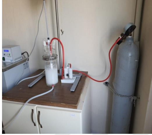
Resim 3.7 CO 2 tüpü ve debimetre ile reaktör içindeki ana çözeltiye CO 2 besleme işlemi.
