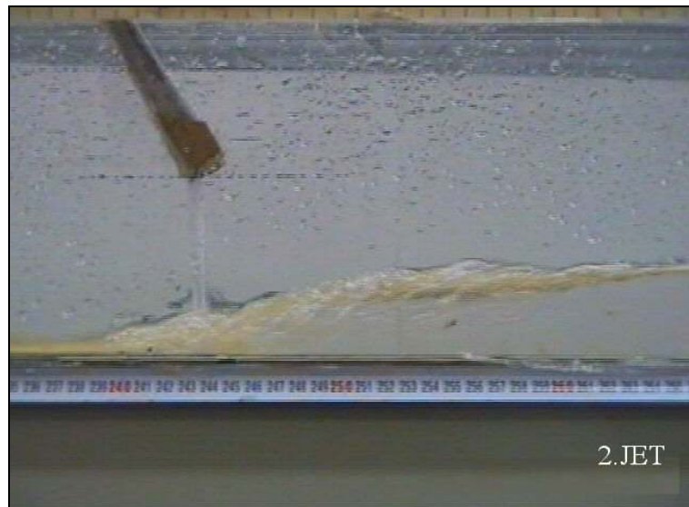
Şekil 3.7 Fr_1=3.43 , jet açısı 60^\circ için hidrolik sıçramalar
