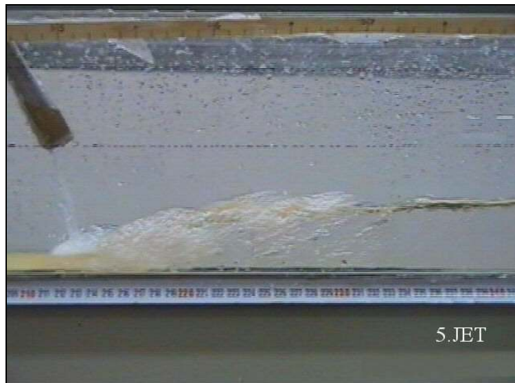
Şekil 3.7 Fr_1=3.43 , jet açısı 60^\circ için hidrolik sıçramalar (devam)
