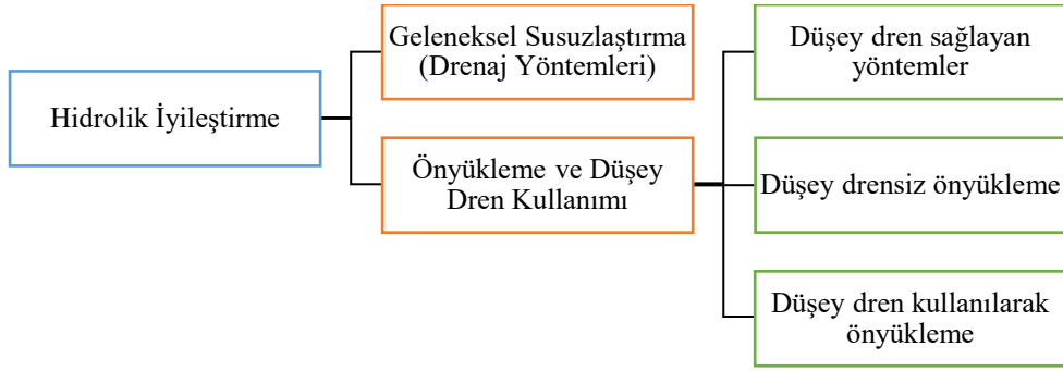
Şekil 2.14. Hidrolik iyileştirme yöntemi sınıflandırması.
