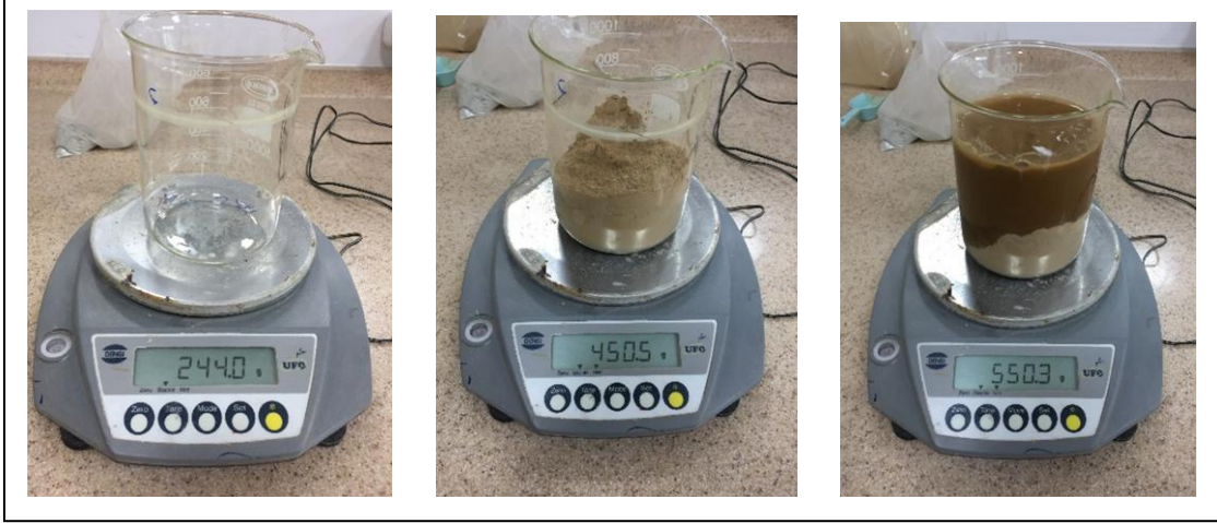
Resim 3.27 Kaymaz cevherinin %45 katı oranlı liç hazırlığı.
