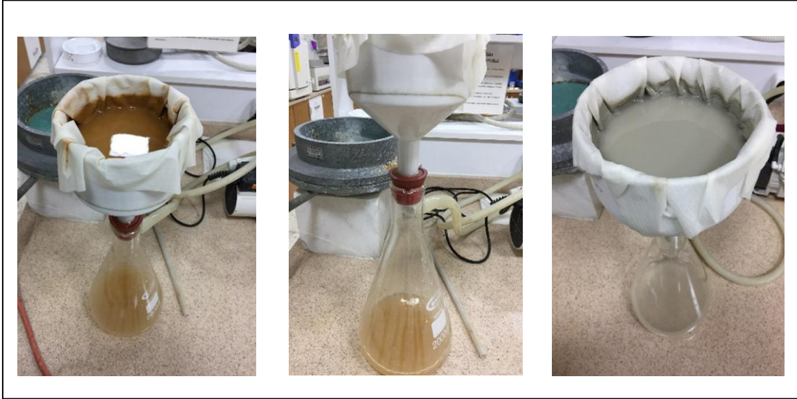
Resim 3.36 Vakum pompası ile katı-sıvı ayırma işlemi.
