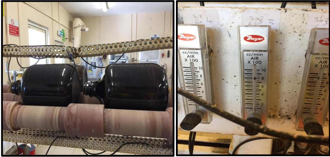
Resim 4.3 Bottle roll düzeneği ve O 2 rotametre ayarları.
