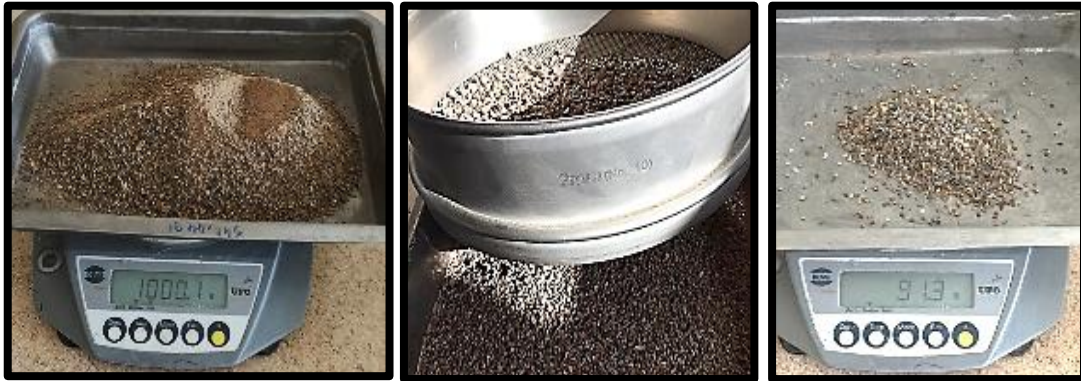
Resim 3.16 Merdaneli kırıcıya beslenen cevherin elek analizi.
