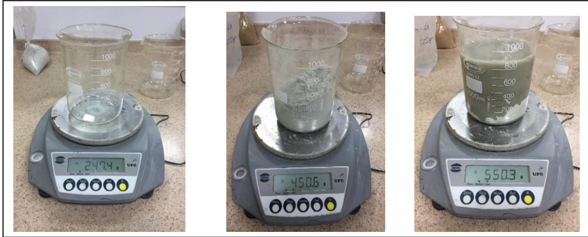
Resim 3.26 Çukuralan cevherinin %45 katı oranı liç hazırlığı.
