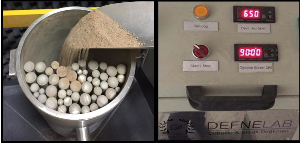
Resim 3.23 2 500 g Kaymaz cevher beslenen laboratuvar tipi değirmen.
