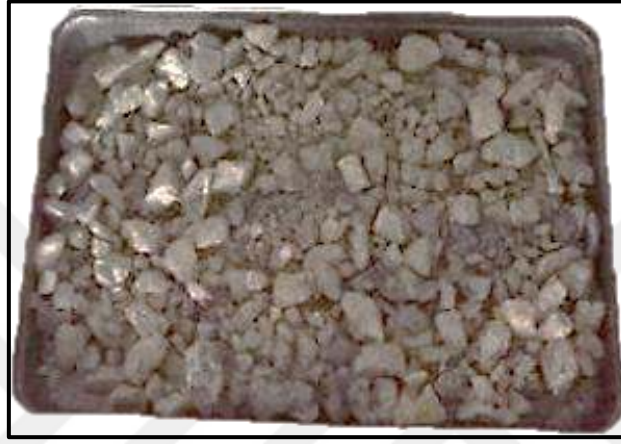
Resim 3.11 Çeneli kırıcıya beslenen Çukuralan cevher numunesi.
