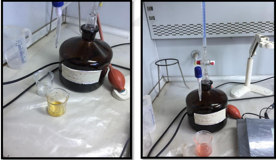
Resim 3.39 Gümüş nitrat titrasyonunda serbest siyanür ölçme işlemi.
