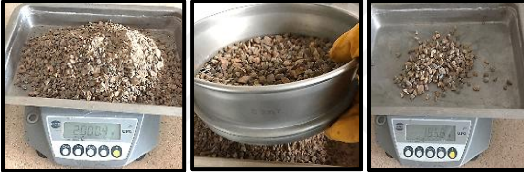
Resim 3.15 Çeneli kırıcıya beslenen Kaymaz cevheri elek analizi.
