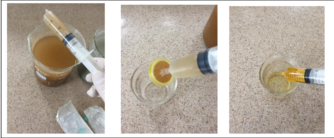
Resim 3.28 20 ml’lik şırınga yardımıyla liç testinden örnek alımı.
