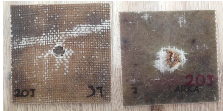
Şekil 3.17 20J enerji uygulanan jüt kumaş/keçe takviyeli numune için darbe hasarı fotoğrafları
