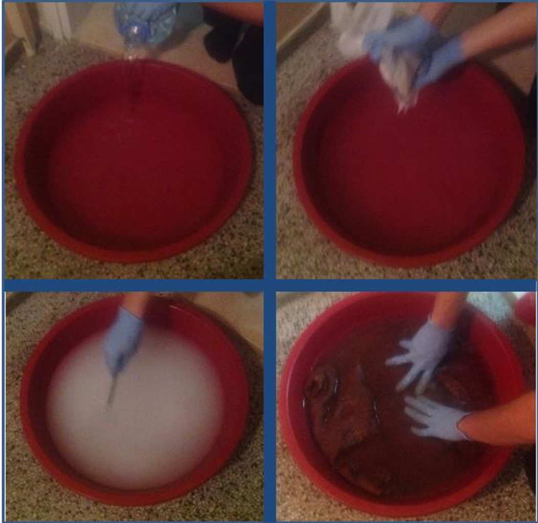
Şekil 2.6 NaOH ile jüt kumaş modifikasyonu
