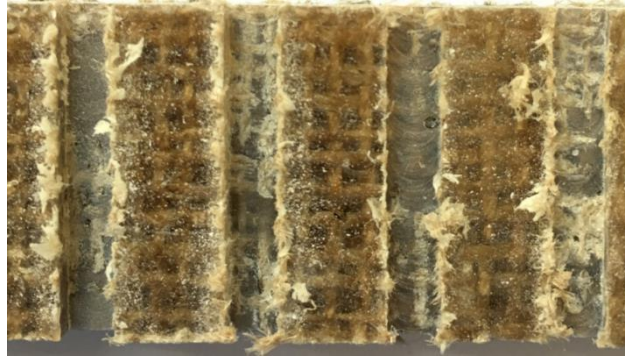
Şekil 4.22. JFTP kompozitin HSS parmak freze çakısı ile frezelenmesinde oluşan deformasyon görüntüleri
