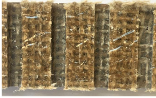
Şekil 4.24. JFTP kompozitin WC parmak freze çakısı ile frezelenmesinde oluşan deformasyon görüntüleri
