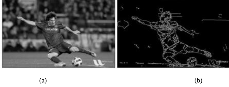
Şekil 3.11. (a) Orijinal Resim, (b) Canny Kenar Bulma Operatörünün Çıktısı
