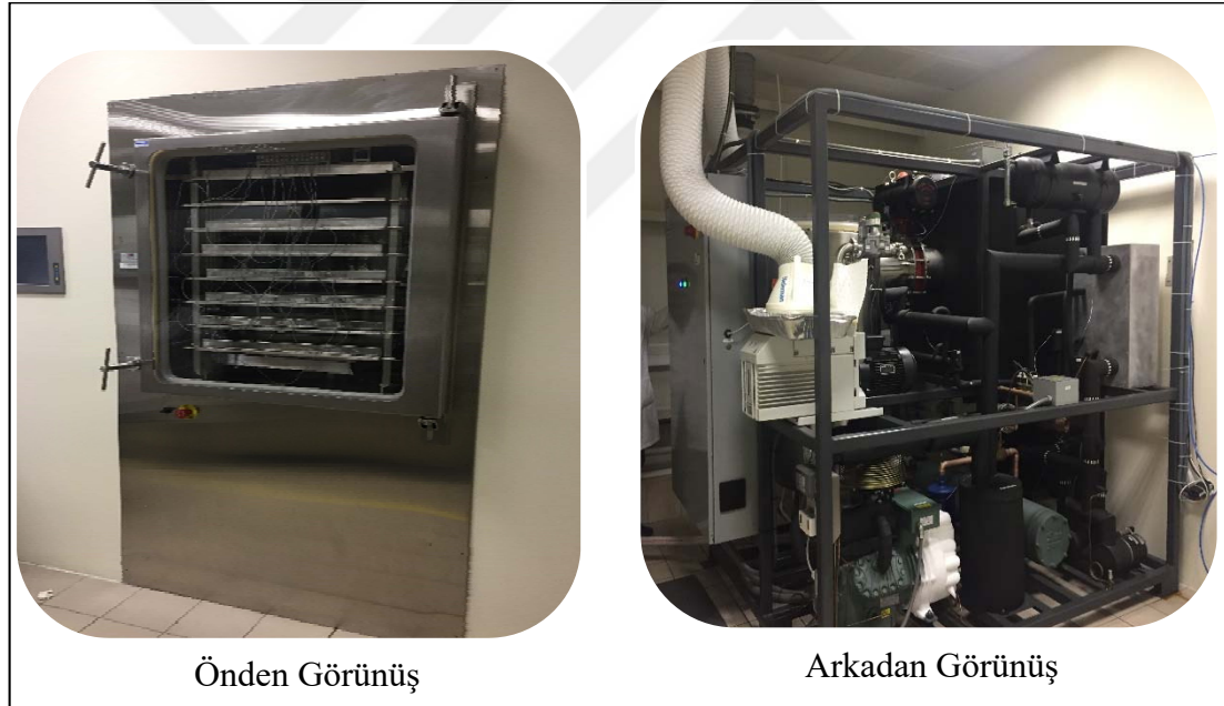
Şekil 3.10 Üretimlerin yapıldığı sanayi tipi liyofilizatör
