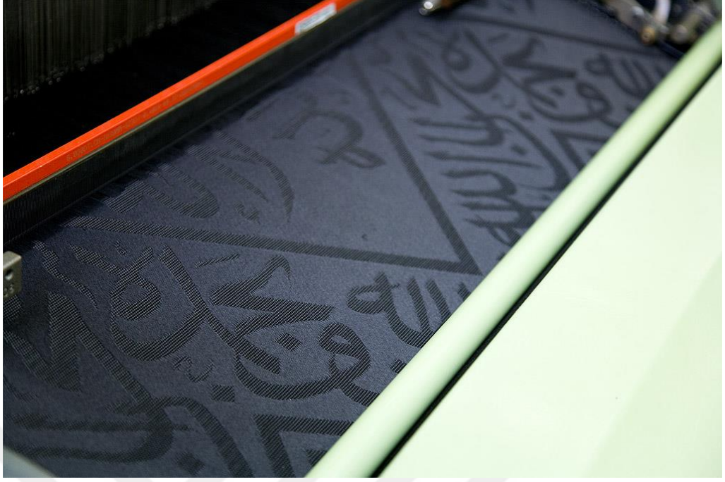
Fotoğraf 2: Jakar düzeni ile dokuma. ( http://factory.alharamain.gov.sa ) (15.11.2016)
