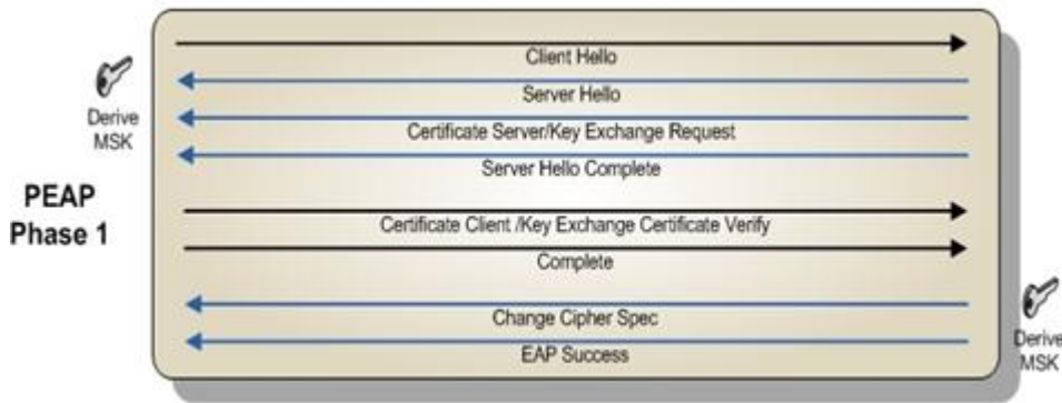
Şekil 3.3. Faz-1’de TLS tünelinin kurulması
