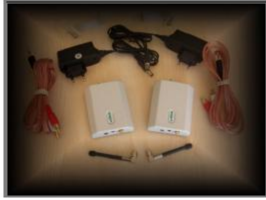
Resim 3.5 Uva-Tr10 Video/Audio Verici Alıcı Seti
