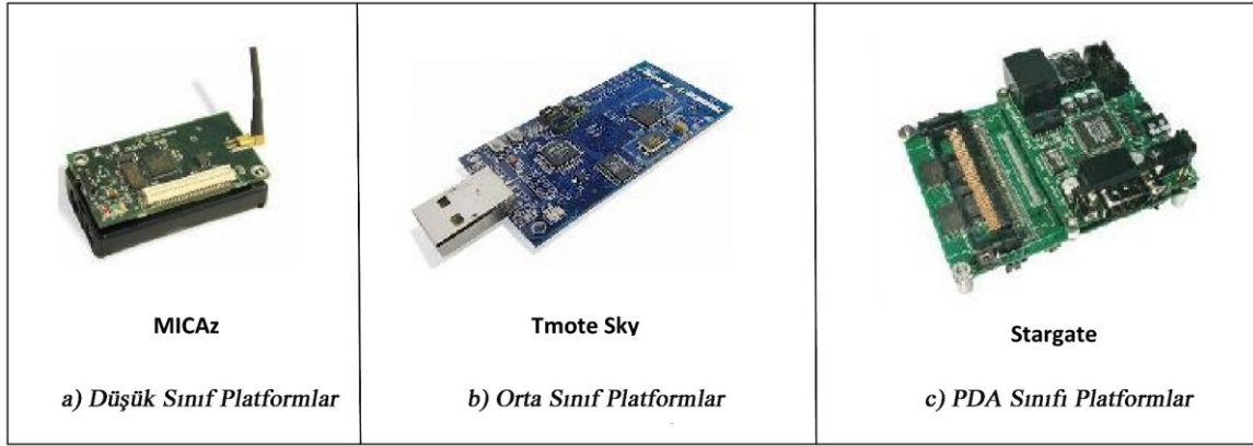
Şekil 2.3. Kablosuz algılayıcı platform örnekleri [21]
