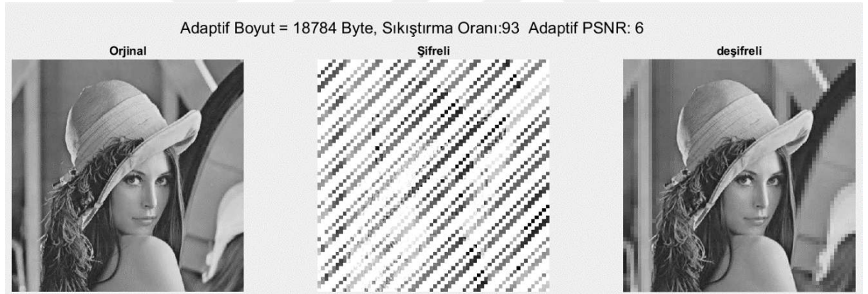
Şekil 7.15. On adet DC katsayı anahtar grubuyla görüntü şifreleme
