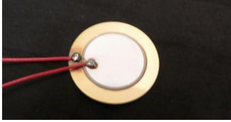
Şekil 3.7 Piezo elektrik sensör üstten görünüşü
