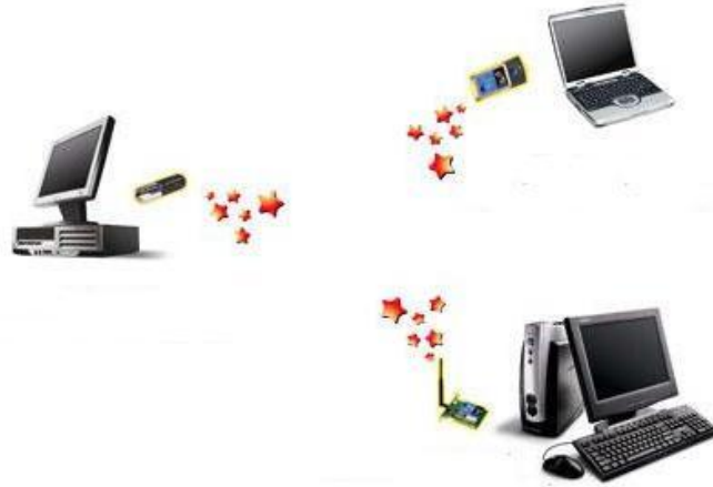
Şekil 1. Bağımsız (Ad Hoc) WLAN Mimarisi[21].
