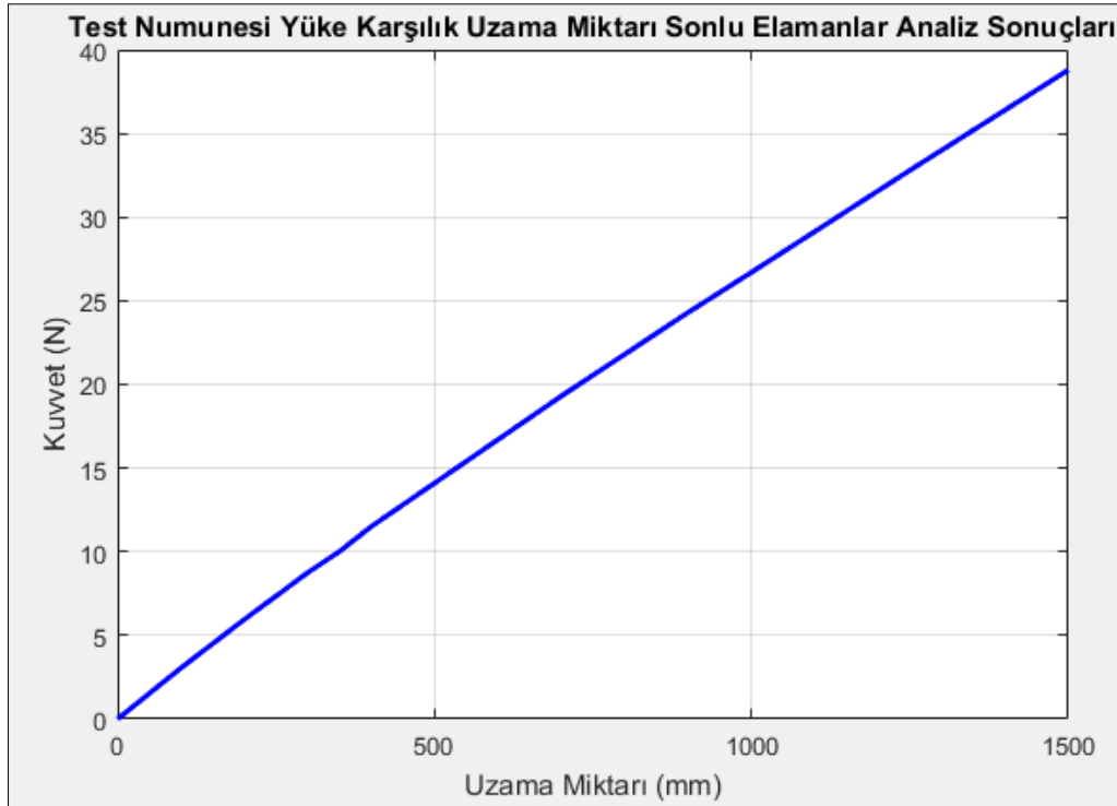
Şekil 5.23. Test numunesi sonlu elemanlar analizi yük – uzama miktarı grafiği
