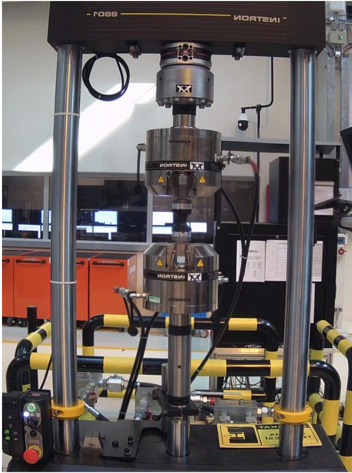
Resim 4.1. Instron 8801 servo hidrolik eksenel test cihazı
