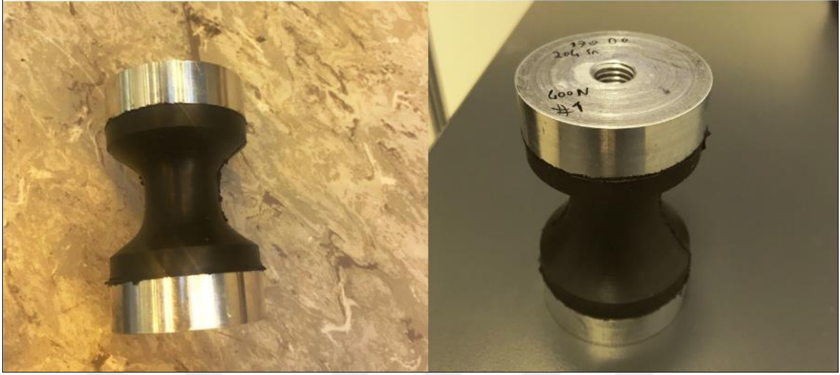
Resim E2.1. Üretim aşaması sonrası diabolo test numunesi
