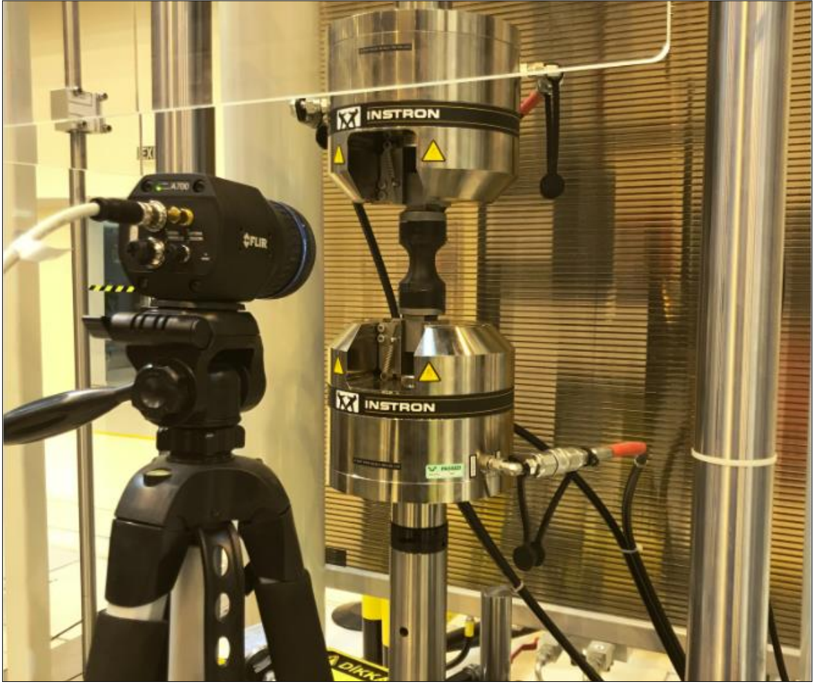
Resim E3.1. Termal kamera ile yüzey sıcaklığı ölçümü düzeneği
