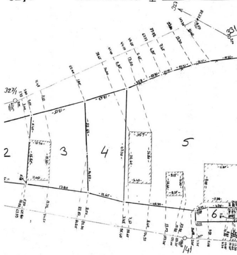
Şekil 3.14. Prizmatik ölçülerden düzenlenmiş kadastro ölçü krokisinden bir kesit.
