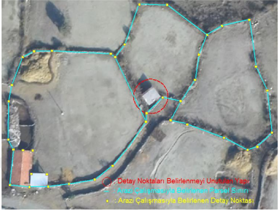
Şekil 4.11. Arazi çalışmasında unutulmuş yapı.
