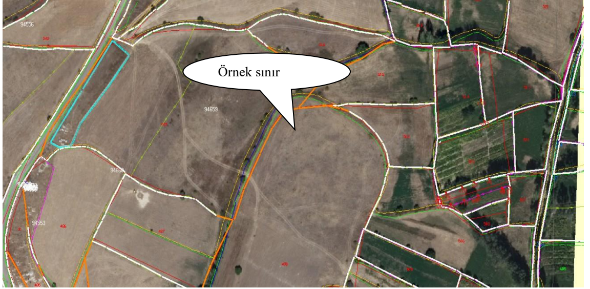
Şekil 24. Birden çok sınır ölçüsü gelmesine örnek (Bayraktar Köyü, Bayburt)
