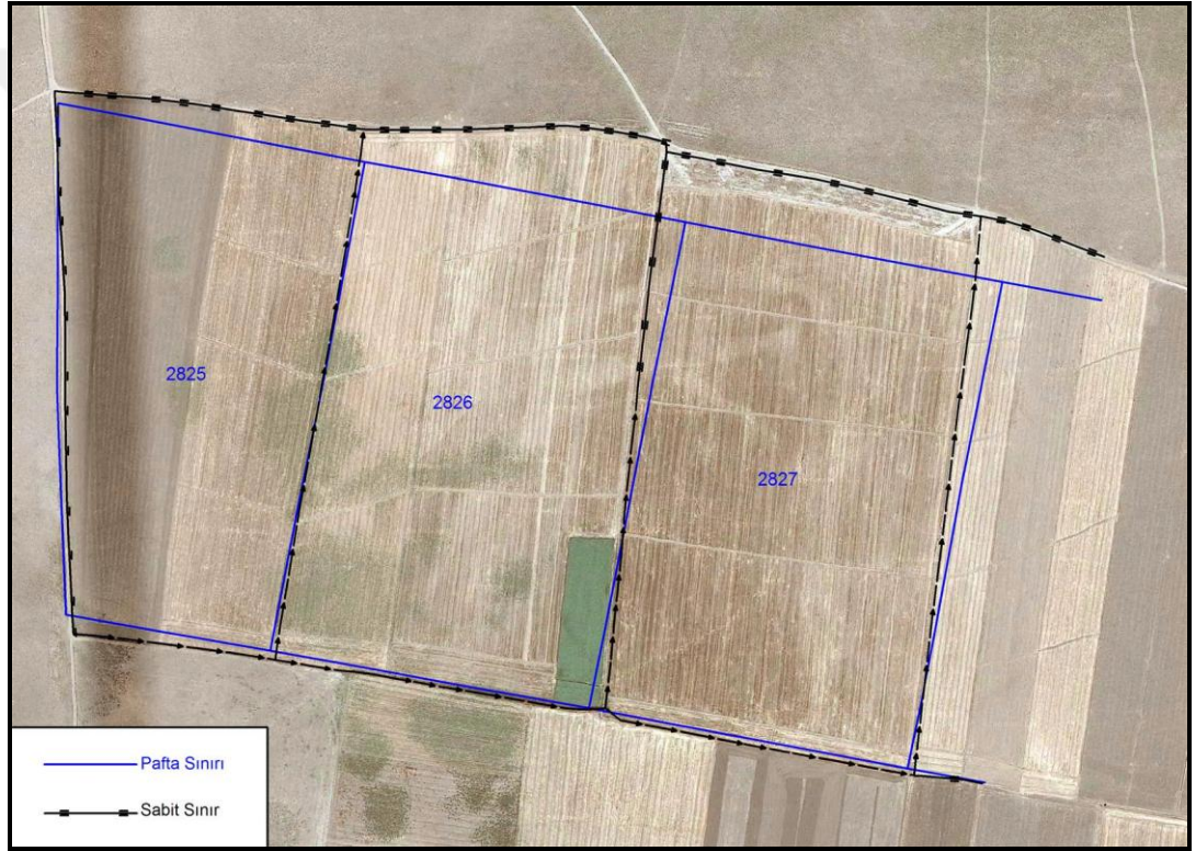
Şekil 10.11: Kadastro pafta sınırı (komisyon) - zemin durumu.
