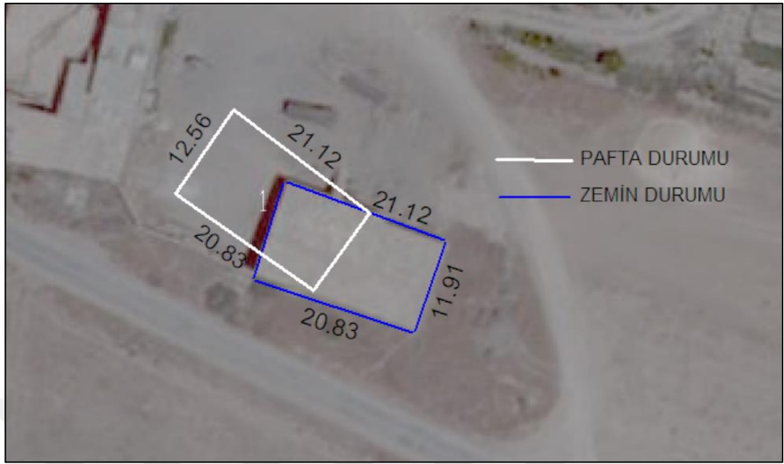
Şekil 3.10. Poligon noktasının koordinatının hesaplanmasına bağlı dönüklük.
