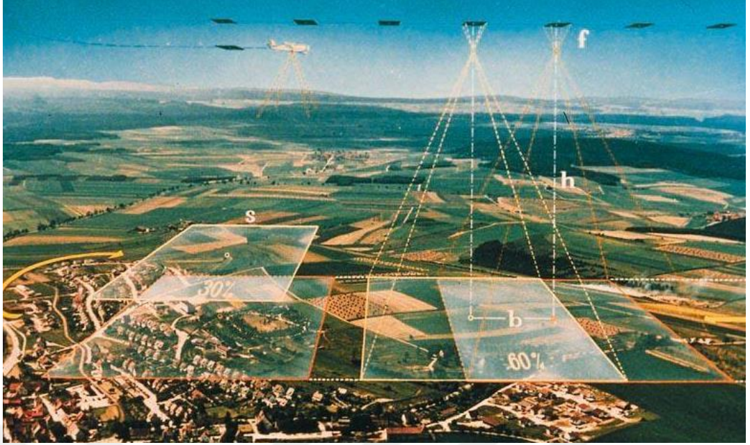
Şekil 3.5. Fotogrametri yöntemi (URL-8).
