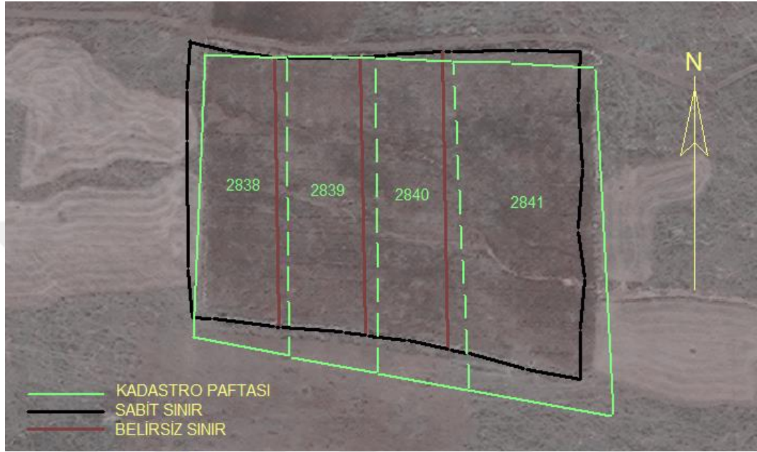
Şekil 4.33. Dengeleme planı pafta zemin karşılaştırılması.
