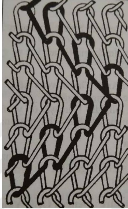
Şekil 117: Tek katlı atlas örgünün şematik görünümü (Marmaralı, vd, 2004: 3)
