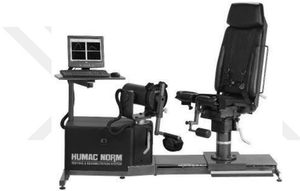
Şekil 3.4. İzokinetik Dinamometre (Humac Norm, CSMI, USA)
