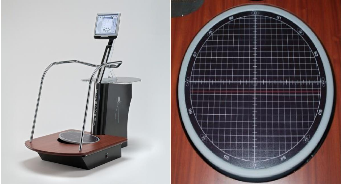
Şekil 3.3.CSMI-Tecnobody PK-252 denge ölçüm cihazı ve cihazın platformu
