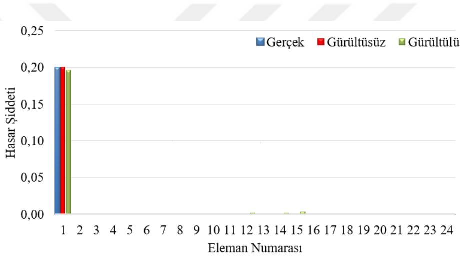
Şekil 18. Betonarme üç boyutlu çerçeve sistem örneğinde birinci senaryo için hasar şiddetleri
