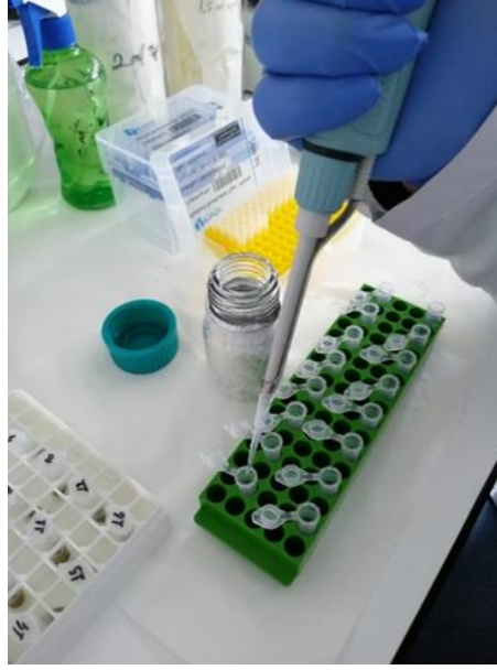
Şekil 2.6. Süpernatantlara kloroform ve NaCl çözeltisinin eklenmesi
