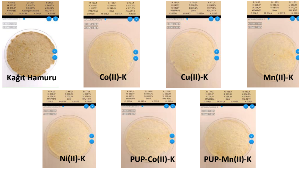
Şekil 6.3. pH-5 Kağıt hamuru ağartma işlemi sonrası.
