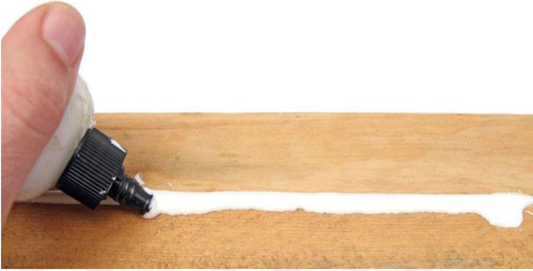
Şekil 1.10. Rezorsin Formaldehit Tutkalı (URL-4)
