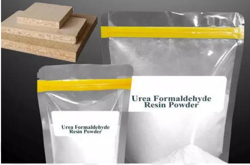
Şekil 1.7. Üre Formaldehit Tutkalı (URL-1)
