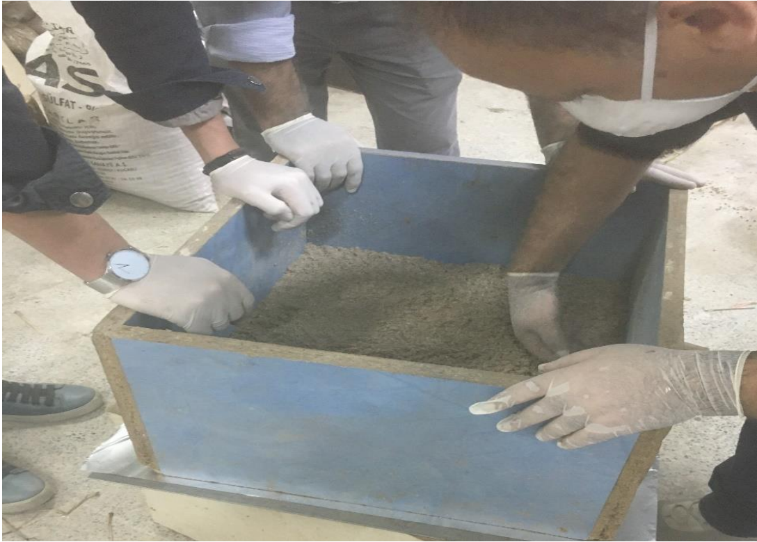
Şekil 2.5. Çamur ve yonga karışımının harmanlanması
