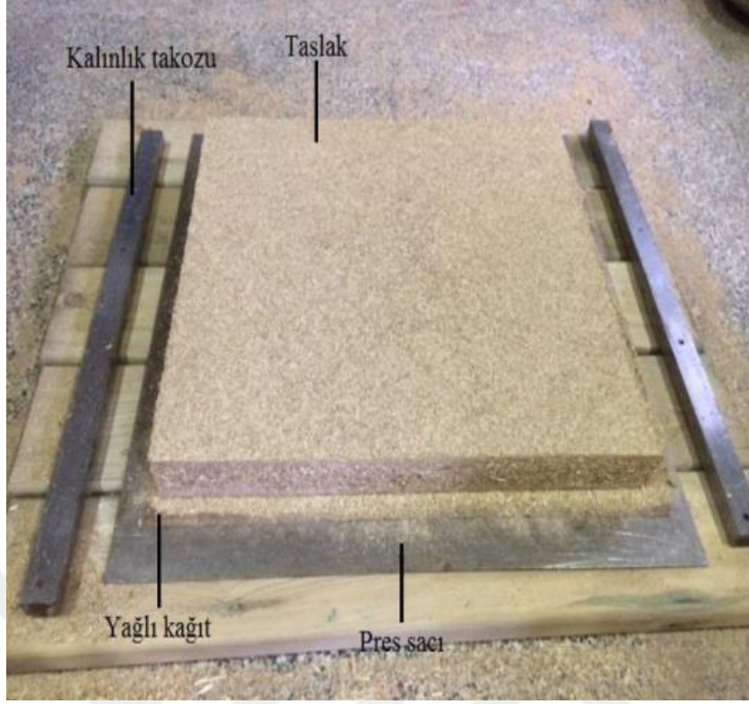
Şekil 2.7. Levha taslağı ve sıcak presleme
