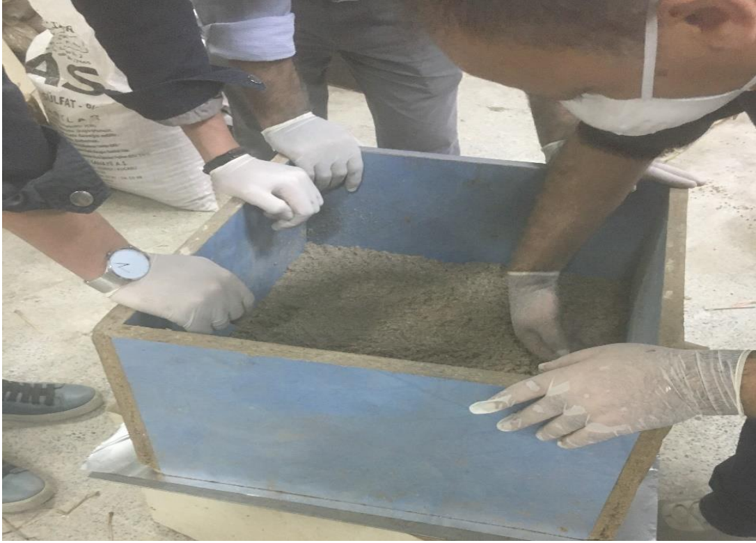
Şekil 2.5. Çamur ve yonga karışımının harmanlanması
