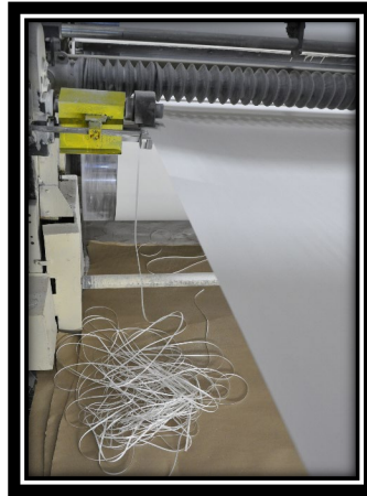
Şekil 1.13: Kesici bıçak yardımıyla fazla kenar payının kesilmesi.
