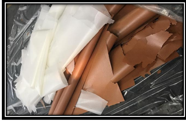
Şekil 1.23: Ham kâğıt ve dekor kâğıtlarına reçine emdirilmesi işlemi esnasında ortaya çıkan atık kâğıt.
