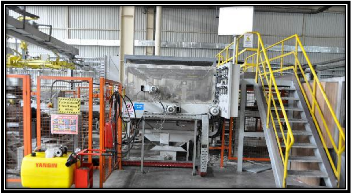
Şekil 1.57: Pres sonrası levha kenarındaki fazla kâğıdı temizleyen ve toplayan makine.
