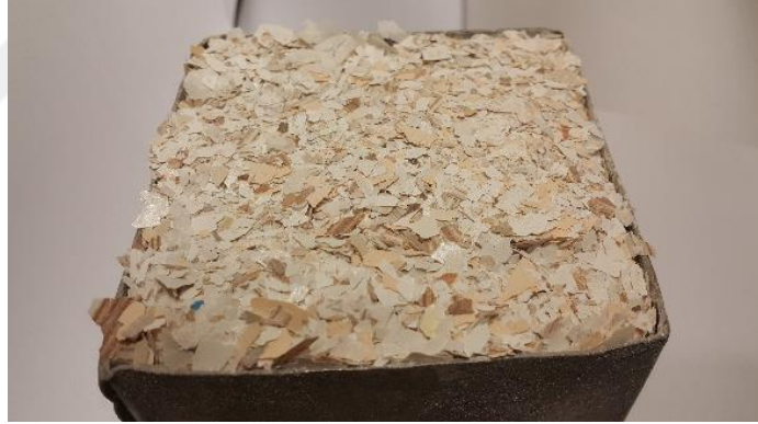
Şekil 1.22: Parçalayıcıdan geçen yeniden kullanıma hazır atık kâğıt.
