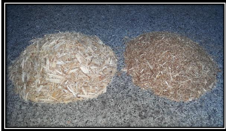
Şekil 2.3: İnceltici değirmenden geçen flake malzeme.
