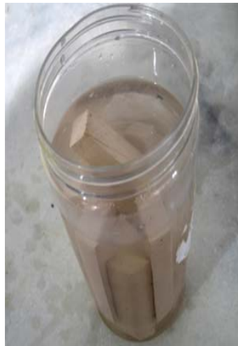
Resim-104 Suyu Doyurulan Deney Çubukları
