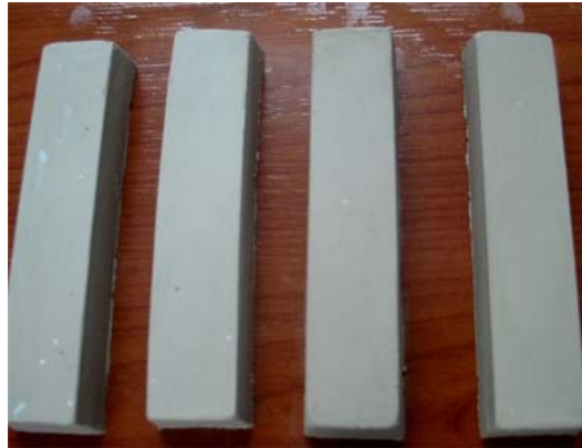
Resim-95 Yoğrulma Suyu Deneyi İçin Hazırlanan Plakalar
