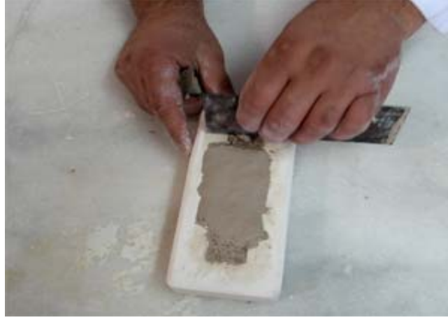
Resim-100 Plastik Kıvamdaki Çamurun Deney Plakasına Basılması
