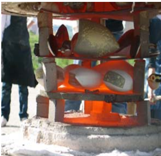
Resim-11 Raku Sırları İle Kaplı Raku Seramiklerinin Sıcak Sıcak Fırından Çıkarılışı (1000°C)
