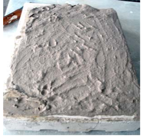
Resim-55 Karışımın Alçı Üzerinde Suyunun Uzaklaştırılması
