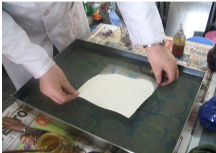
Resim-40 Kâğıt Katkılı Seramik Bünyenin Ebru Teknesine Konulması
