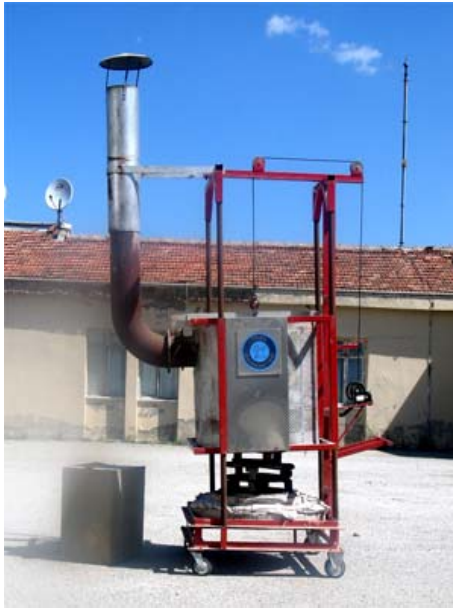
Resim-45-46 Vinç Sistemli Gazlı Raku Fırını
