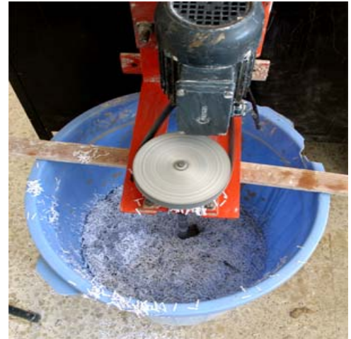
Resim-48 Doğranmış Kâğıtların Su ile Karıştırılması
