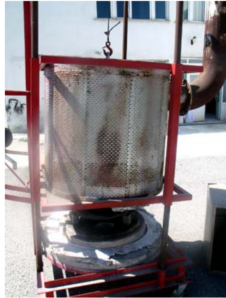
Resim-45-46 Vinç Sistemli Gazlı Raku Fırını
