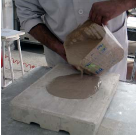
Resim- 54 Karışımın Alçı Üzerine Dökülmesi
