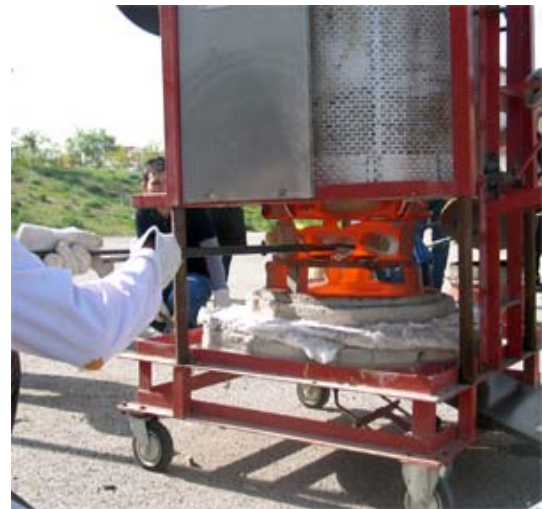
Resim-11 Raku Sırları İle Kaplı Raku Seramiklerinin Sıcak Sıcak Fırından Çıkarılışı (1000°C)
