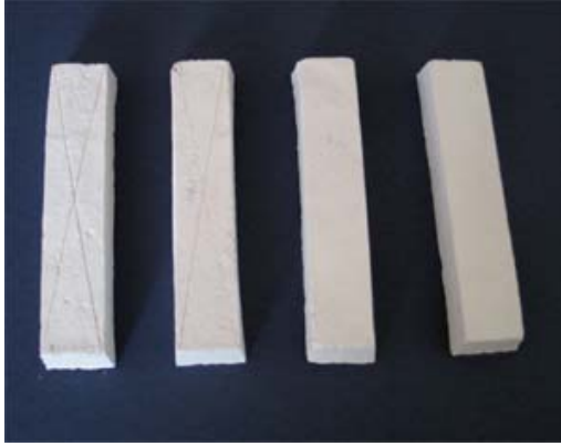
Resim-102 Büskivi Pişirimi Yapılmış Deney Çubukları
