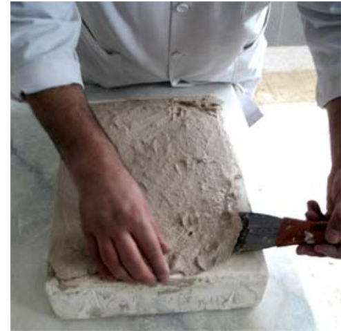
Resim-56 -Kâğıt Katkılı Seramik Bünyenin Alt Üst Edilmesi
