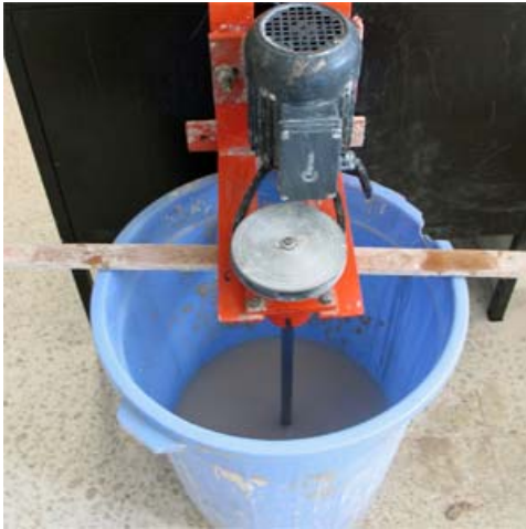
Resim-48 Doğranmış Kâğıtların Su ile Karıştırılması
