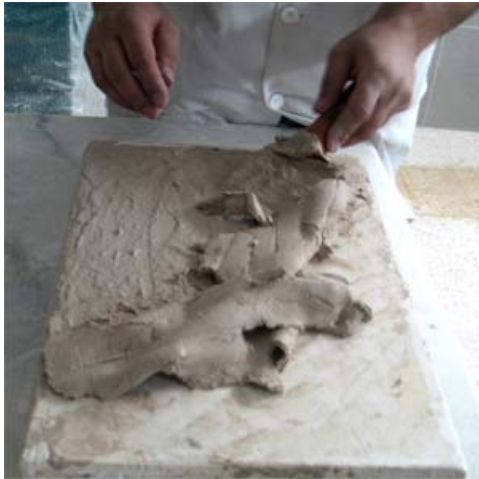
Resim-56 -Kâğıt Katkılı Seramik Bünyenin Alt Üst Edilmesi
