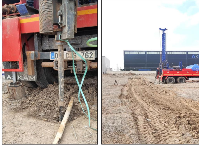
Şekil 6.4. Temel sondaj kuyularında Otomatik Şahmerdan ile SPT deneyinin yapılışı
