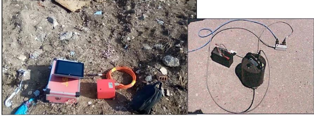
Şekil 6.12. GURALP CMG-6TD 3 bileşenli mikrotremör cihazı
