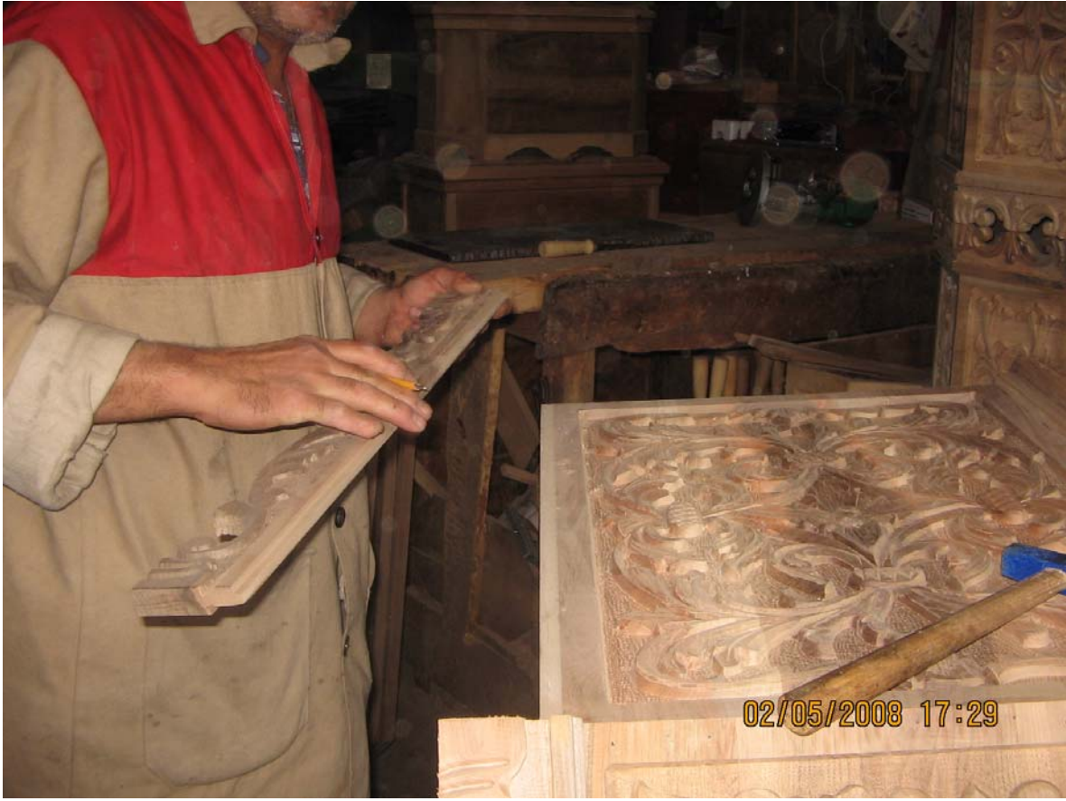
Fotoğraf 28: Sandık ayağına oyulan ahşap parçalarını birleştirme
