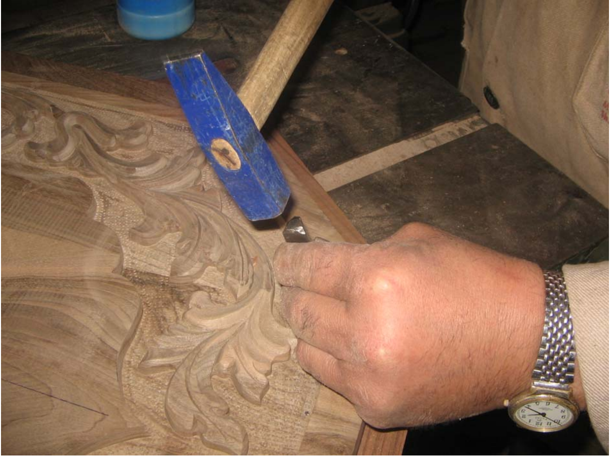
Fotoğraf 24: Eklenen parçanın çıkmaması için çivi çakma işlemi
