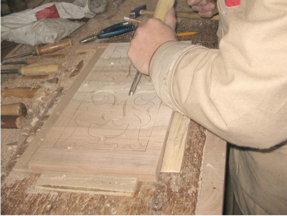
Fotoğraf 11: Ahşap yüzeye çizilen desenin iskarpela ile oyulması
