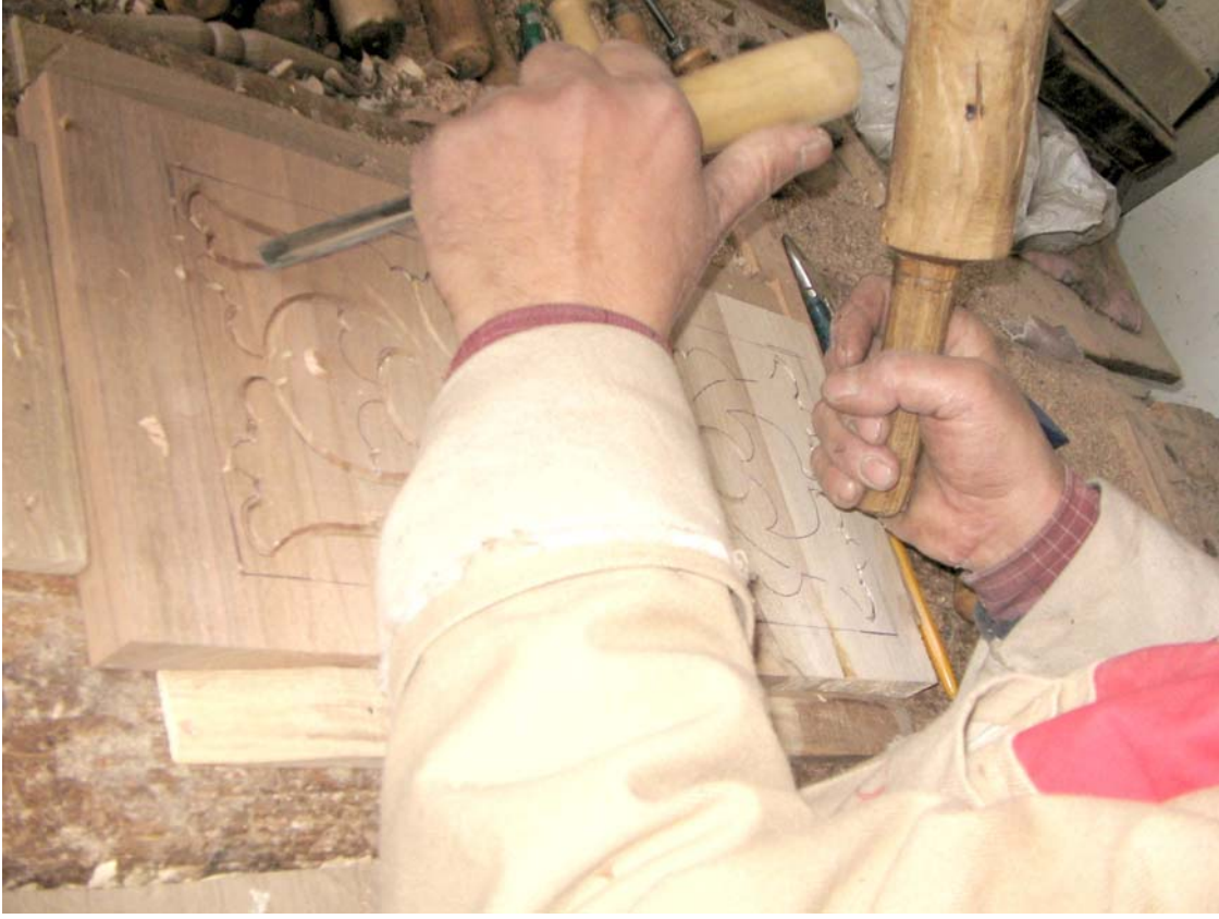
Fotoğraf 12: İskarpelaya tokmakla vurularak oyma işleminin yapılması
