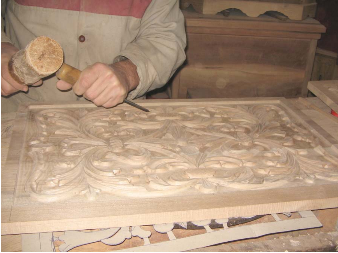
Fotoğraf 14: Oyma sandığın ön parçasının oyması yapılırken
