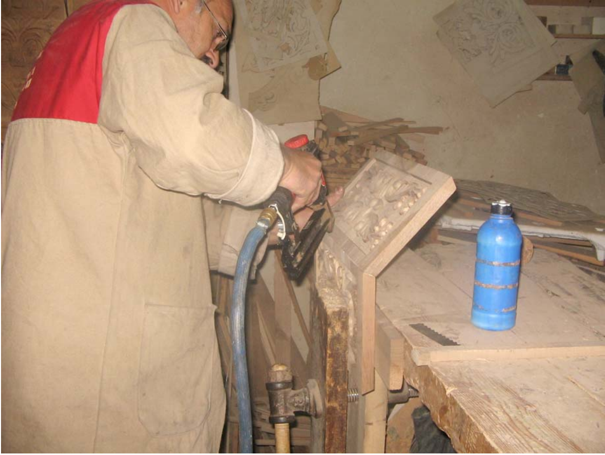
Fotoğraf 18: Yapıştırılan ahşap parçaların çivi tabancasıyla çivilenmesi
