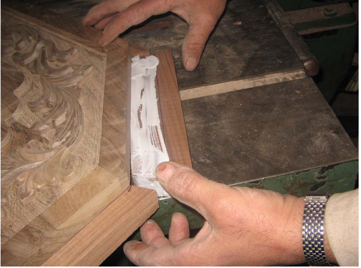
Fotoğraf 23: Tutkallanan parçanın sandık kapağına yapıştırılması
