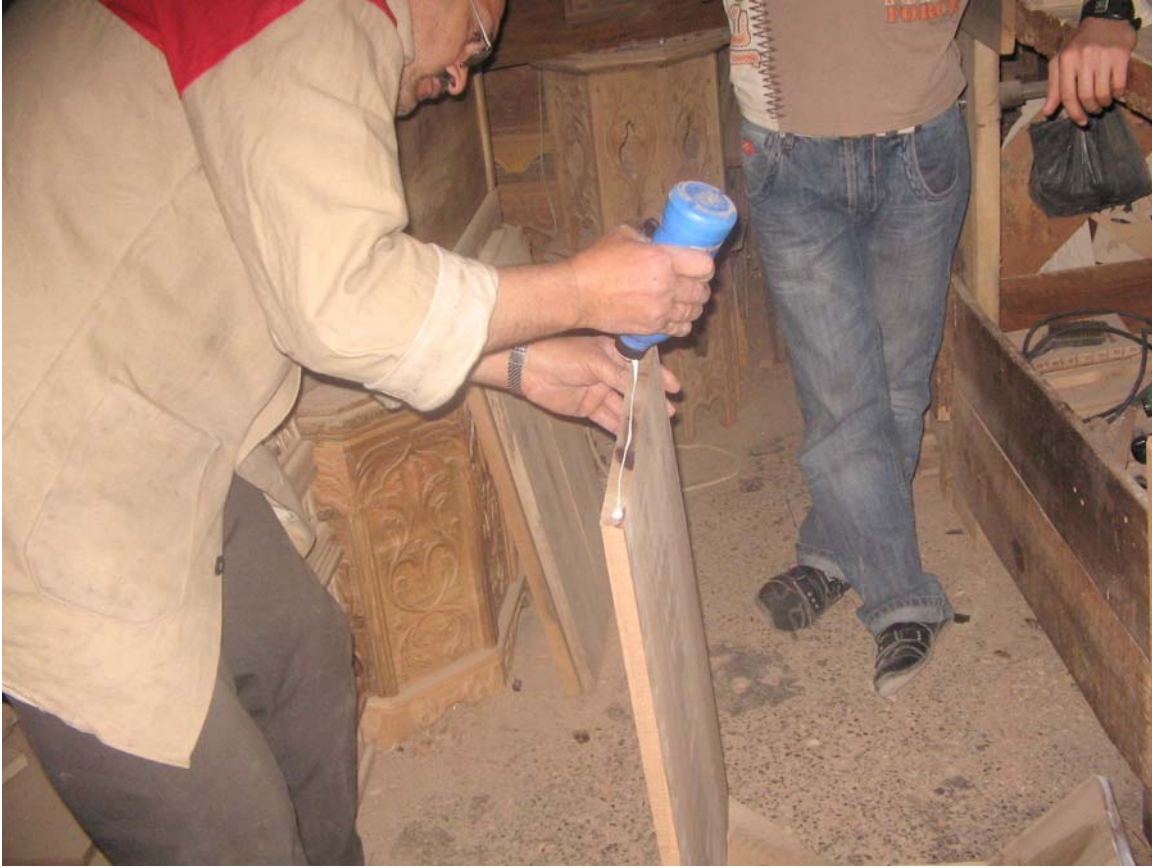
Fotoğraf 19: Ön yüzdeki parçaların birleştirilmek için tutkalllanması
