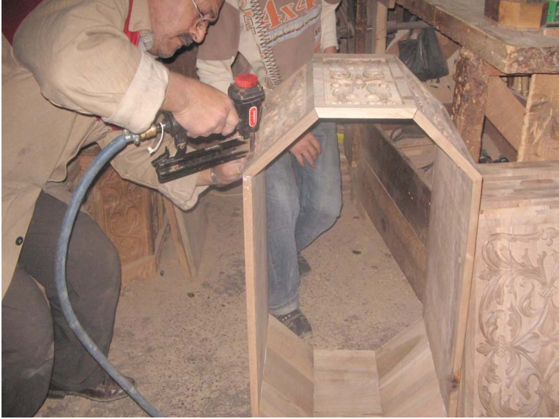
Fotoğraf 20: Tutkalla birleştirilen parçaların çivi tabancasıyla çivilenmesi
