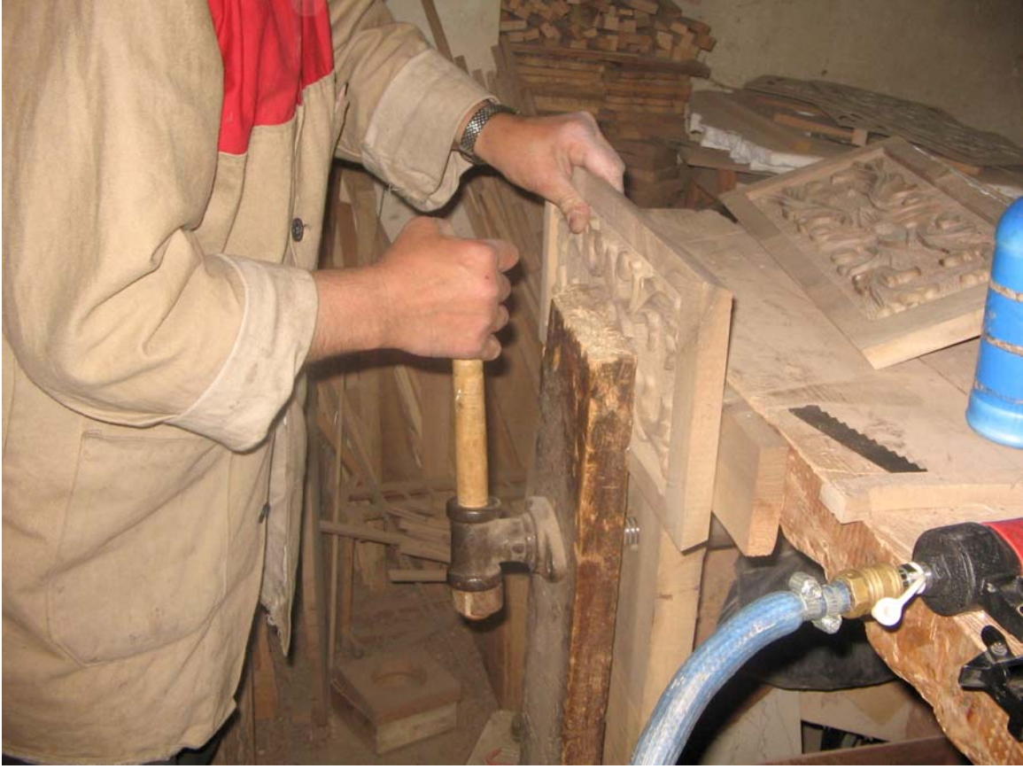
Fotoğraf 15 :Oyma parçaların mengene yardımıyla sıkıştırılma işlemi
