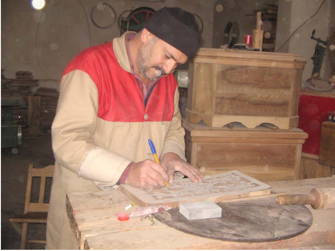
Fotoğraf 10: Şablon halindeki desenin ahşap yüzey üzerine çizilmesi
