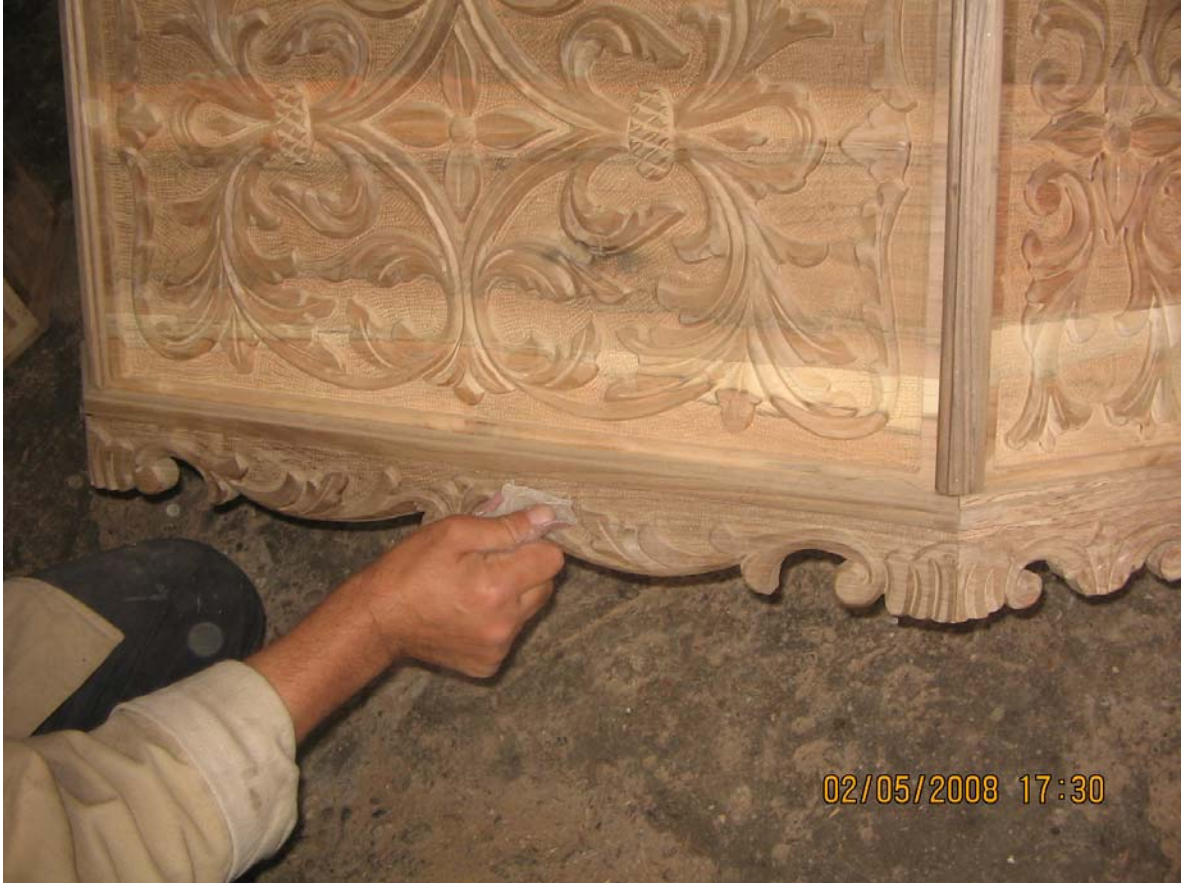
Fotoğraf 29: Ayak kısmının sandığa eklenmesi ve zımparalama işlemi
