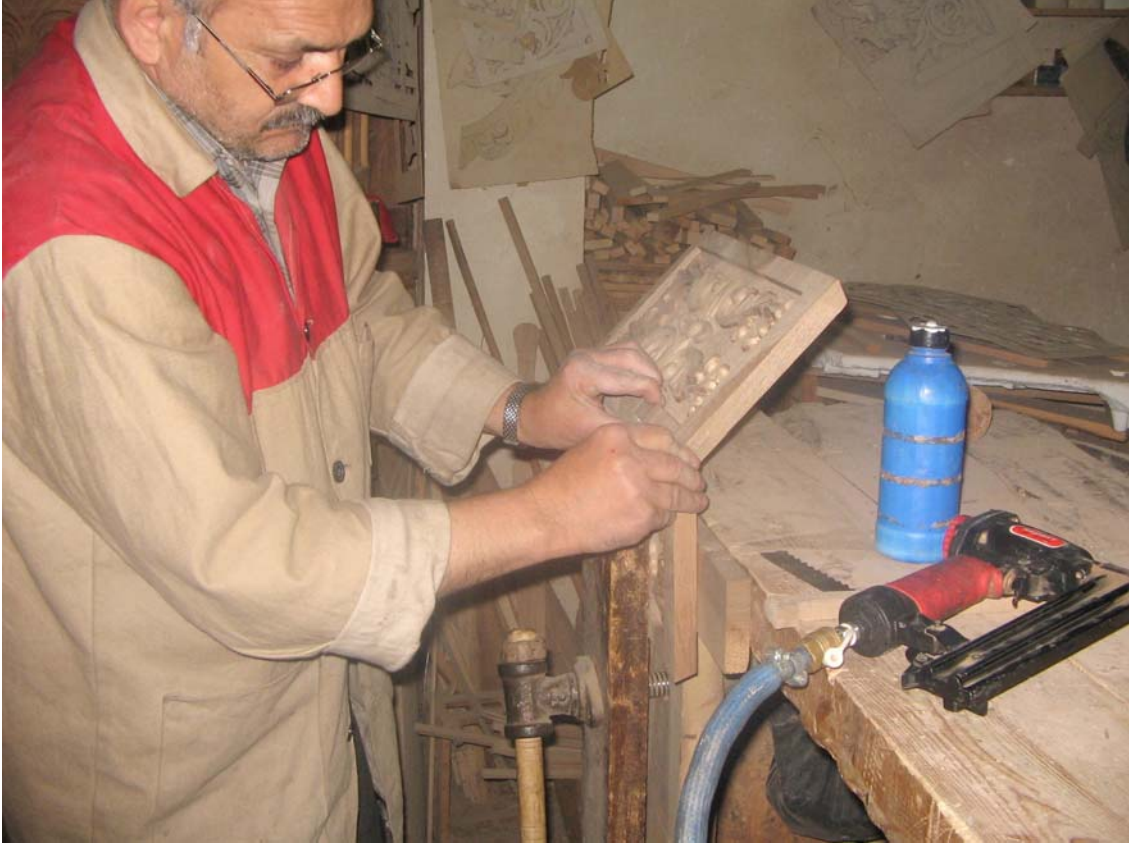
Fotoğraf 17: Tutkal sürüldükten sonra birleştirilen parçaların görüntüsü
