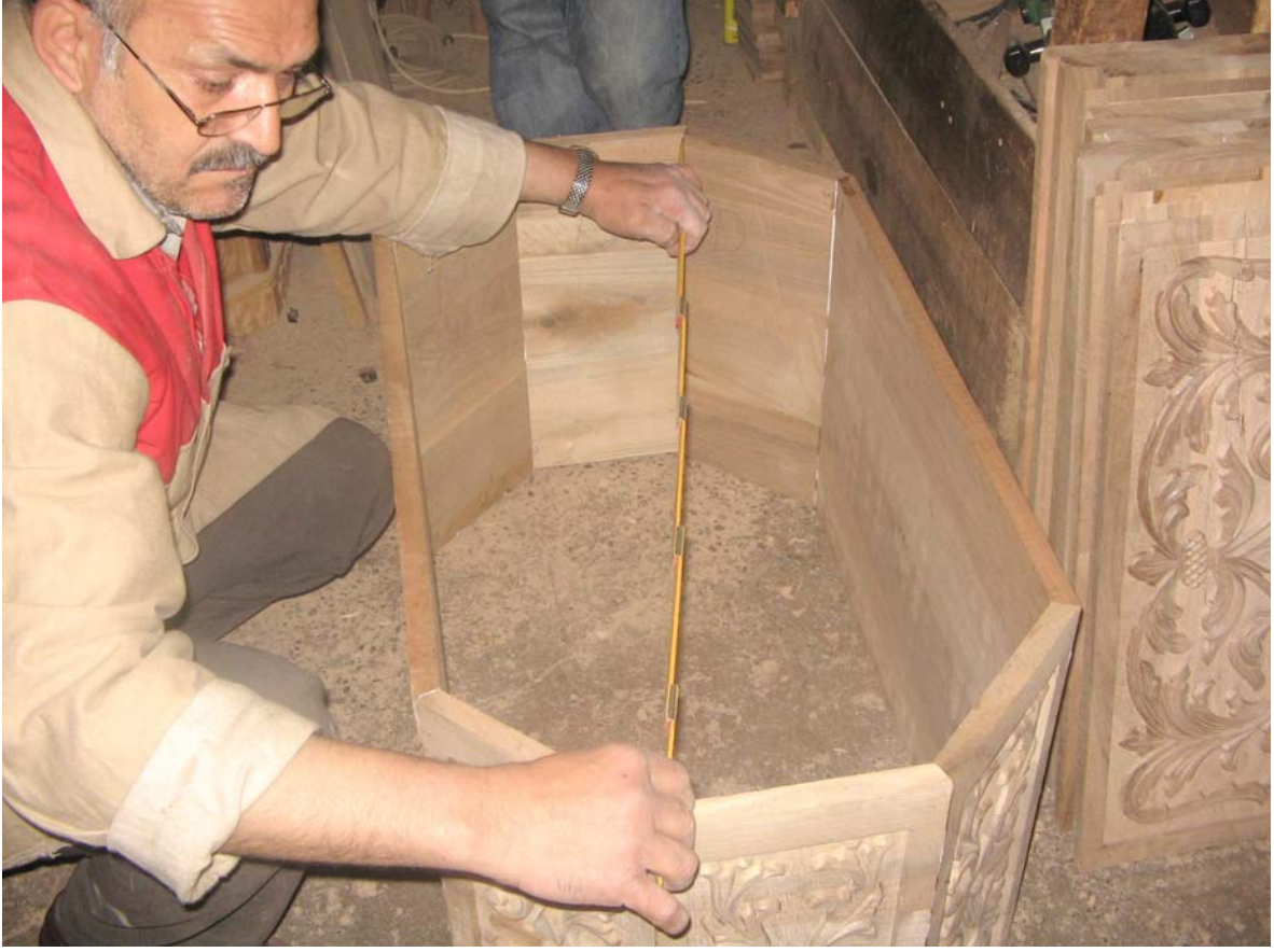
Fotoğraf 21: Parçaları birleştirilen sandığın kaymalara karşı ölçülmesi
