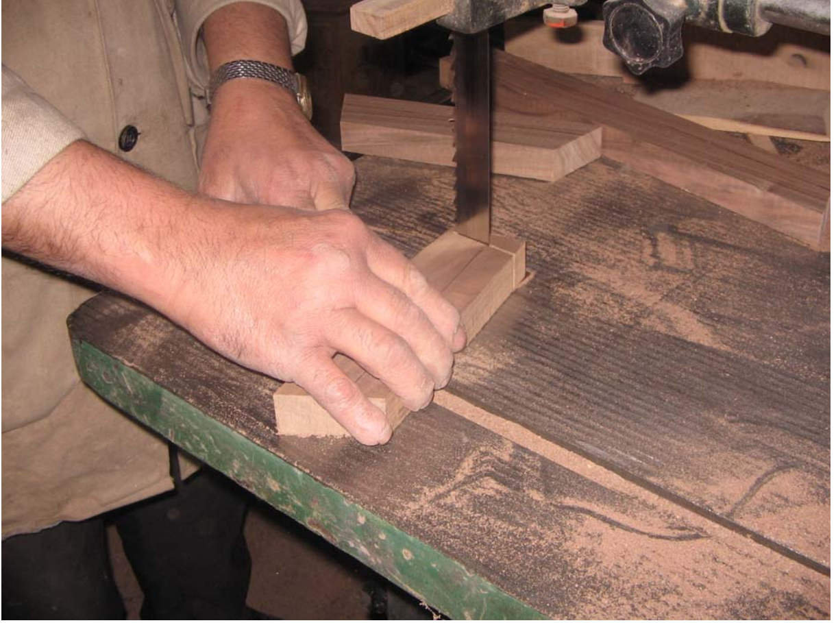
Fotoğraf 22: Sandık kapağına eklenmek üzere parçaların kesilmesi
