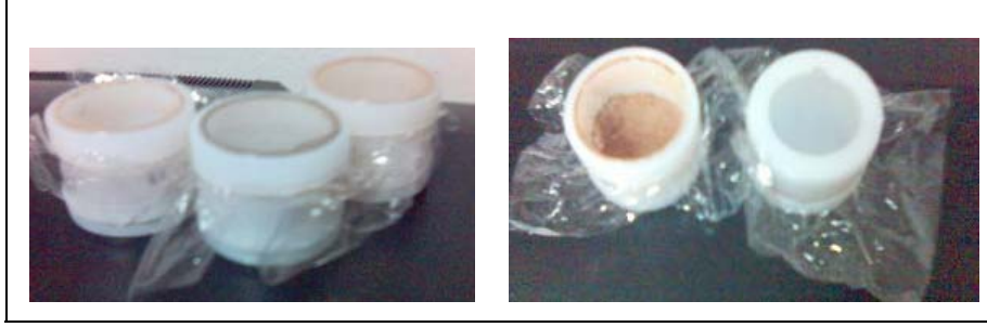
Resim 3.9. Mylar film kaplı numune kaplarına hazırlanmış toz numuneler
