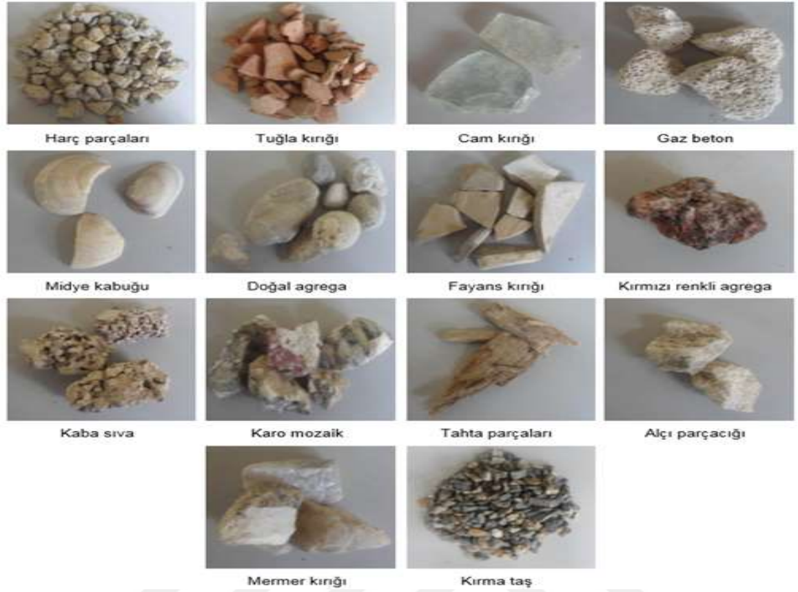
Şekil 5.9. Geri Dönüştürülmüş İYA İçeriğinde Çıkan Malzemeler (Çakır, 2012; Terzi, 2000).
