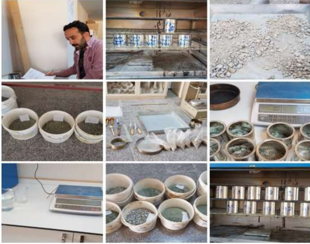
Şekil 4.10. Modifiye Proktor Deneyi
