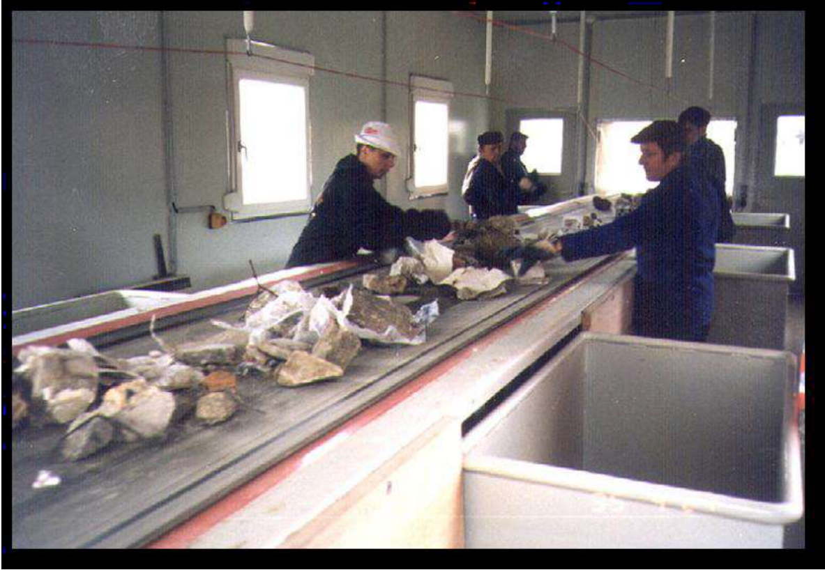
Şekil 2.8. El İle Ayırma İstasyonu İç Kısmı (URL-2, 2019).
