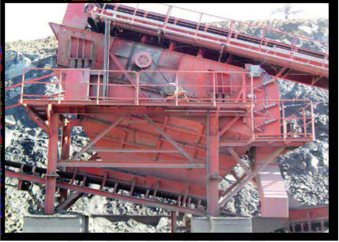
Şekil 2.12. Konvansiyonel Titreşimli Elekler (URL-2, 2019).
