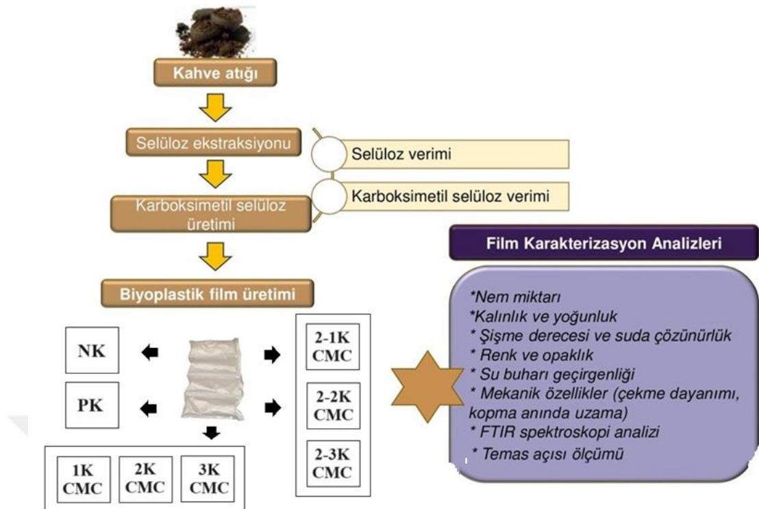
Şekil 3.1. Deneme Deseni (NK: Yalnızca polivinil alkol ile üretilen film; PK: Hazır ticari karboksimetil selüloz ile üretilen film; Deneme 1KCMC, 2KCMC, 3KCMC: Kahve atığından elde edilen karboksimetil selüloz (üç farklı oran) içeren filmler; Deneme 2-1-KCMC, 2-2-KCMC, 2-3-KCMC: Sabit oranda hazır ticari karboksimetil selüloz kullanımı ve kahve atığından elde edilen karboksimetil selüloz (üç farklı oran) içeren filmler).
