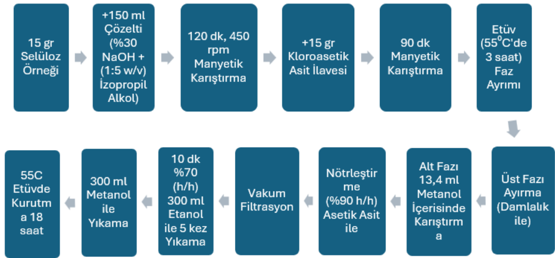
Şekil 3.3. Karboksimetil selüloz ekstraksiyonu akım şeması.
