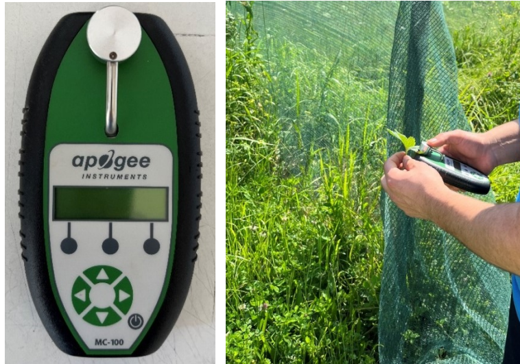
Şekil 19. Klorofilmetre ile bitkilerin SPAD deęerleri ölçümü
