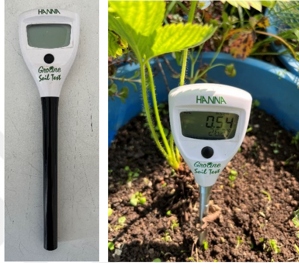
Şekil 20. Doğrudan Toprak İletkenlik Test Cihazı ile yetiştirme ortamı iletkenlik değeri ölçümü
