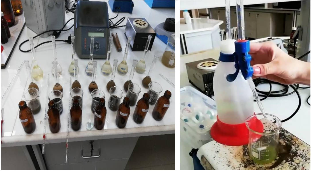
Şekil 3.3. KOİ deneyi öncesi seyreltme işlemleri ve DAS ile titrasyon.
