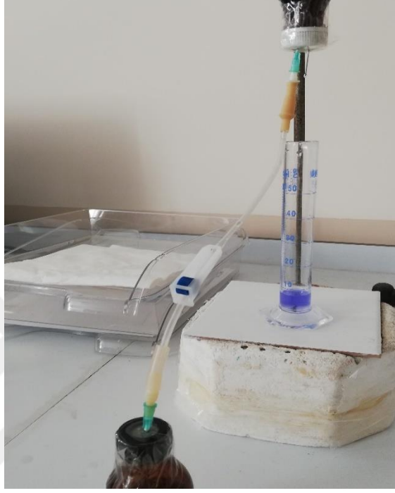
řekil 4.1. Yer deęiřtirme yöntemiyle metan ölçümü.
