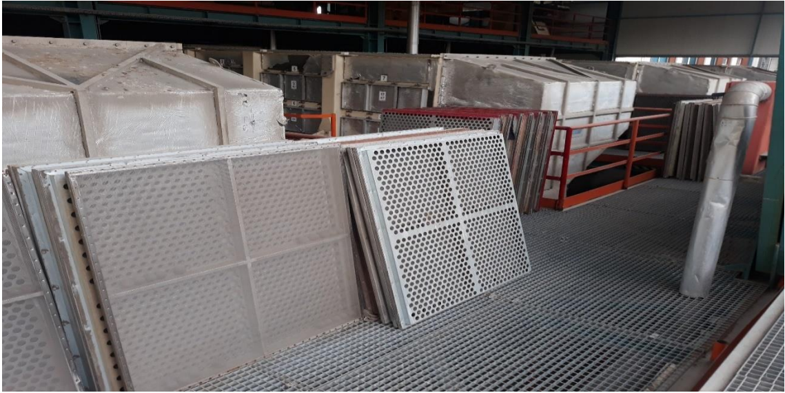
Şekil 2.4. Yonga elek örneği ve mekanik eleme sistemi.
