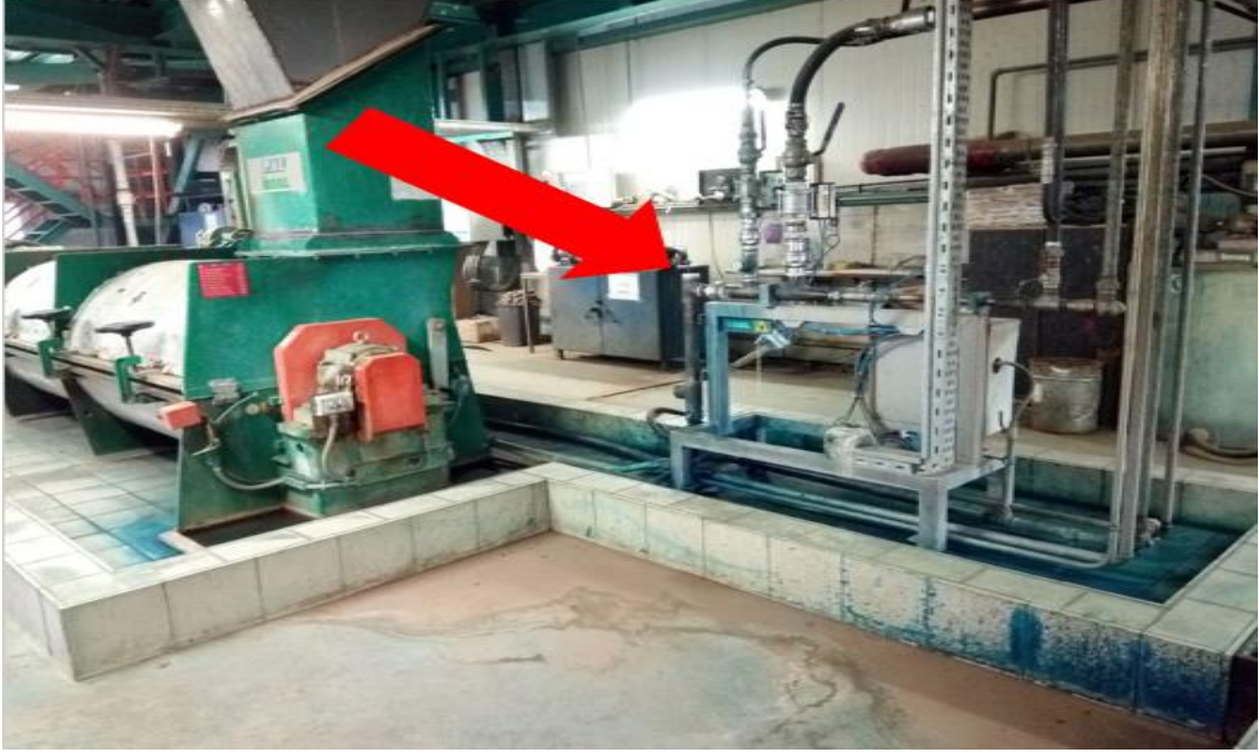
Şekil 4.1. Üretimde kullanılan kimyasalların karıştırıldığı statik mikser.
