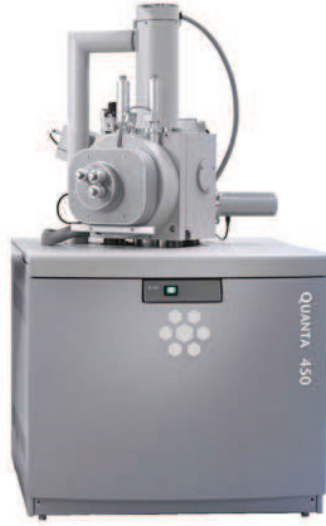
Şekil 4.2. FEI QUANTA FEG 450, alan emisyonlu taramalı elektron mikroskobu.
