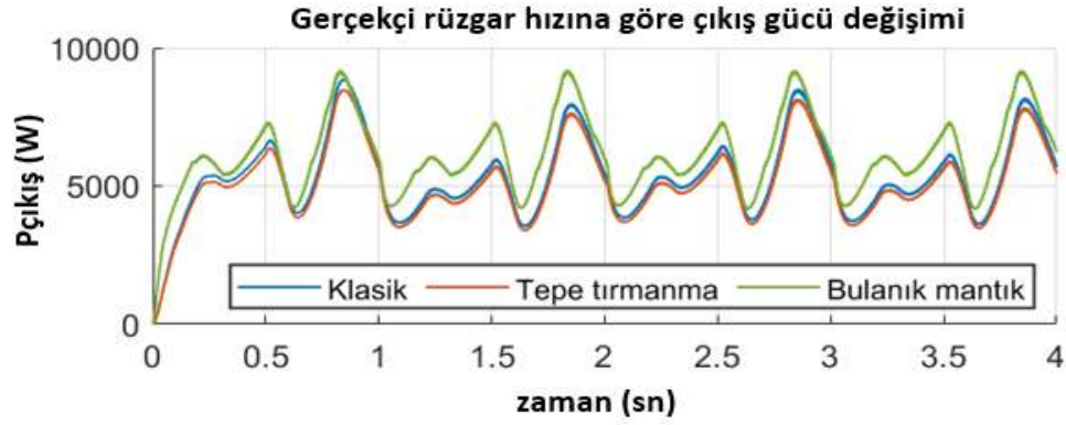
Şekil 5.34. Gerçekçi rüzgârda farklı kontrol yöntemlerine göre kıyıcı çıkış gücü değişimleri
