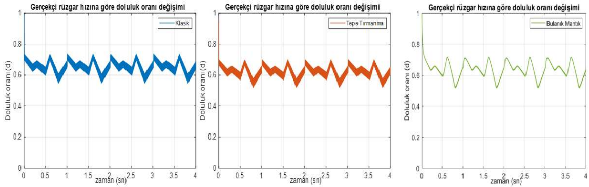
Şekil 5.35 Gerçekçi rüzgârda farklı kontrol yöntemlerine göre doluluk oranı değişimleri
