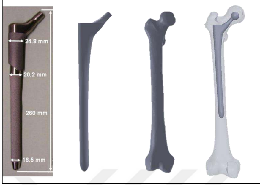
Şekil 19. Kalça protez modeli ve femur kemiğine yerleştirilmesi
