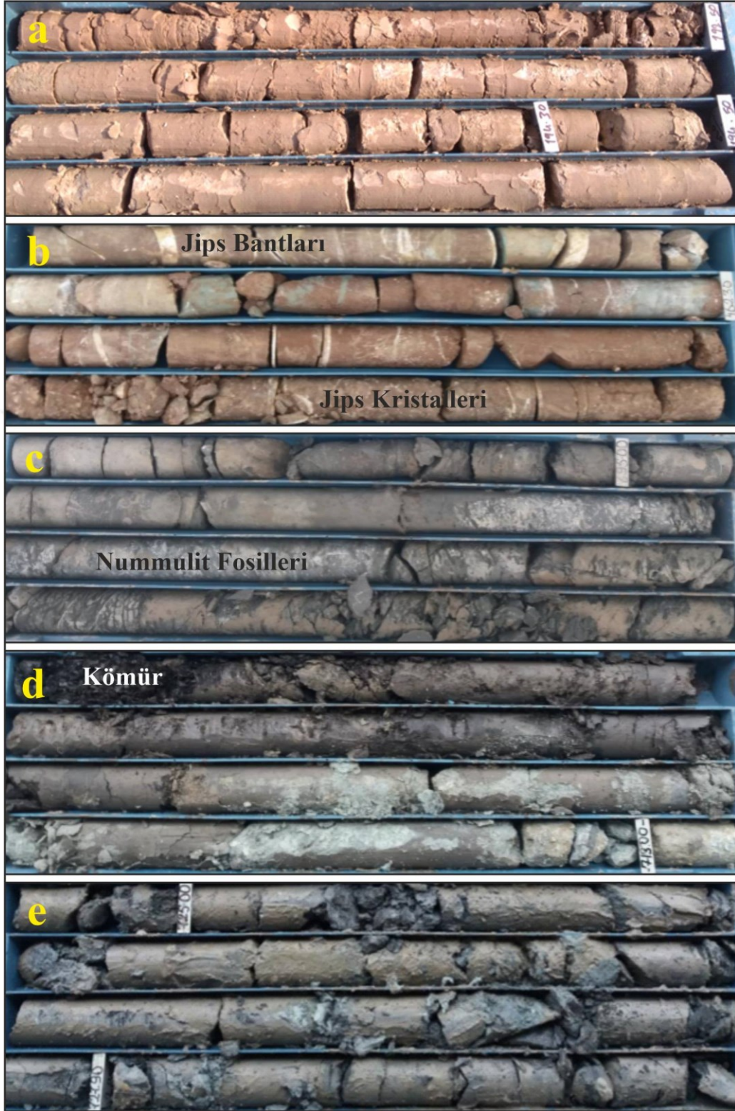
Şekil 4.16 TK2 sondajına ait karot fotoğrafları a) orta ile zayıf pekleşmiş kalkerli çamurtaşı seviyeleri, b) jips bantlı, jips kristalli, yer yer anhidrit nodüllü, kahve renkli, yer yer yeşil, kalkerli çamurtaşı ve kilaşı seviyeleri, c) yer yer nummulit fosilleri içeren killi karbonat, d) siyahımsı renkte yumuşak linyitten oluşan bir kömür seviyesi içeren silttaşı ve kilaşı, e) Kretase yaşlı volkanik temel.
