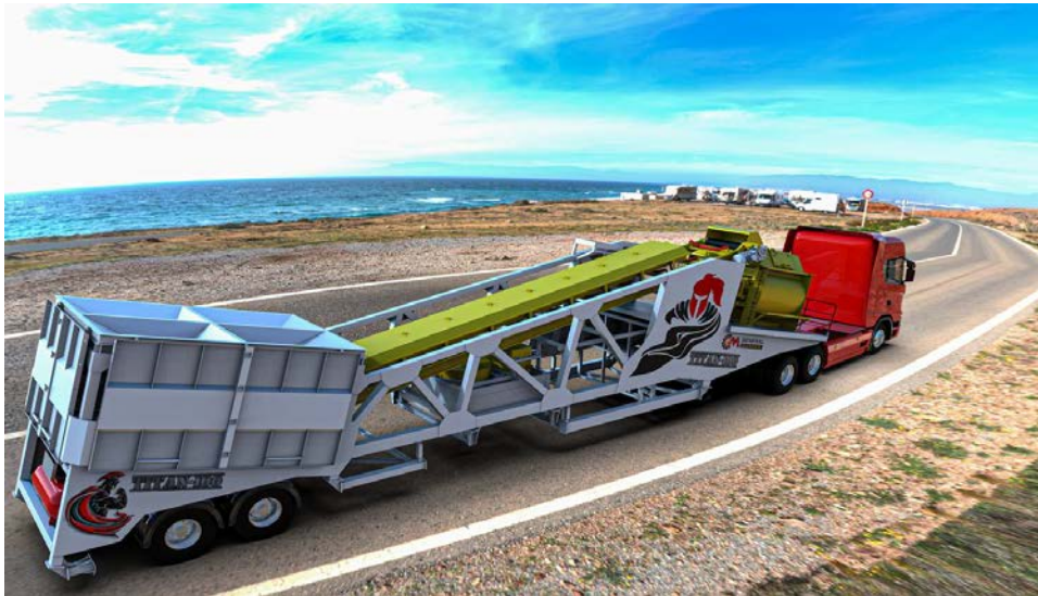
Şekil 5. Mobil hazır beton tesisi (GM. 2022).
