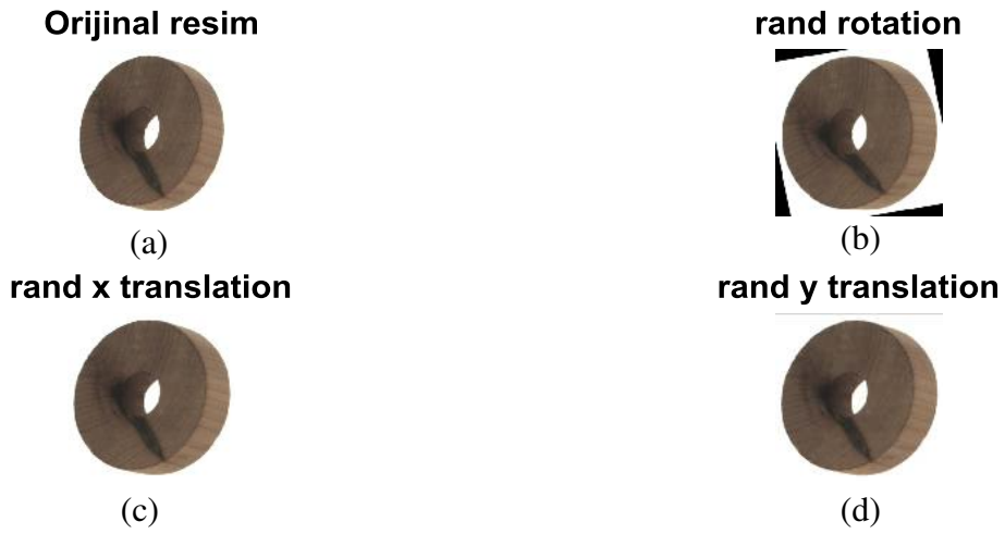
Şekil 4.30. Kusurlu bir ürüne görüntü çoğaltma teknikleri uygulaması
