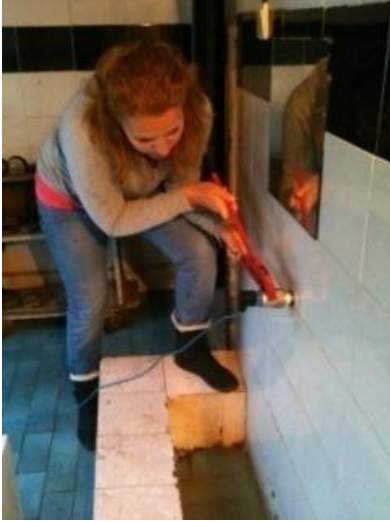
(a) Sahada manuel basınç ölçümü için basınçmetrenin takılması
