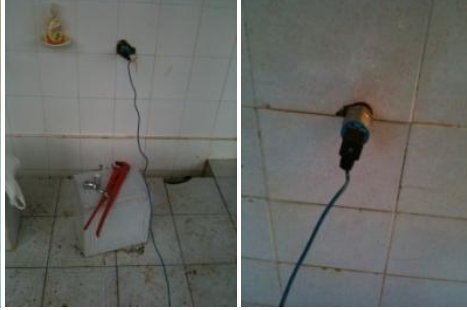
(a) Sahada manuel basınç ölçümü için basınçmetrenin takılması
