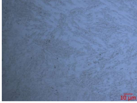
Şekil 7.5 N kalıp çeliğinin 50x objektif ile alınan 30 saniye % 2 nital ile dağlanmış metal mikroskop görüntüsü
