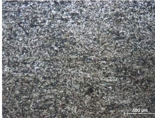
Şekil 7.18 2311-1 kalıp çeliğinin 50x objektif ile alınan 30 saniye %2 nital ile dağlanmış optik mikroskop görüntüsü
