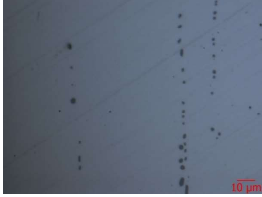
Şekil 7.9 R kalıp çeliğinin 50x objektif ile alınan 30 saniye %2 nital ile dağlanmış metal mikroskop görüntüsü
