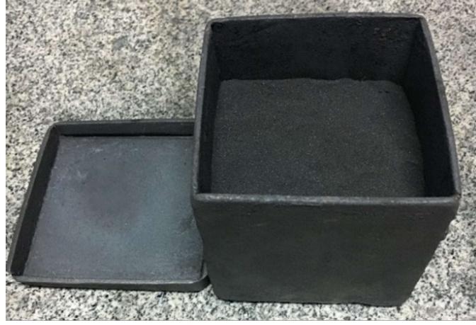
Şekil 6.14 Borlama işleminde kullanılan borlama kutusu (Kişisel arşiv, 2020)
