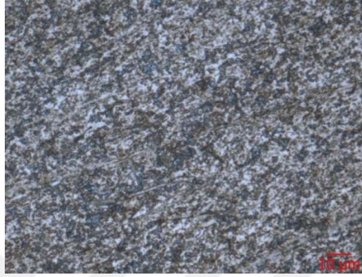
Şekil 7.17 2311-1 kalıp çeliğinin 50x objektif ile alınan 30 saniye %2 nital ile dağlanmış metal mikroskop görüntüsü
