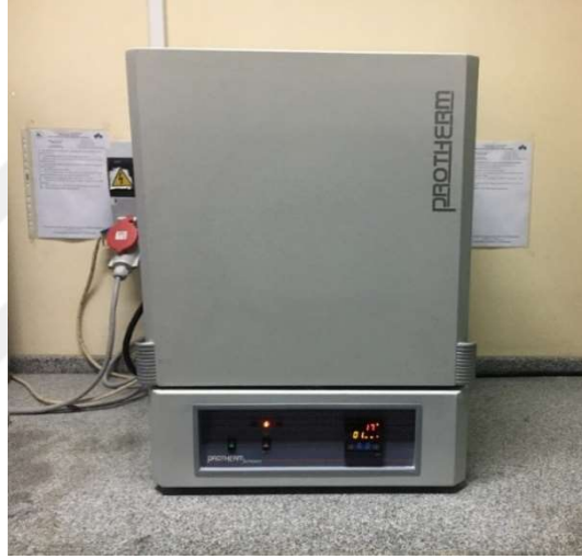
Şekil 6.13 Borlama işleminde kullanılan borlama fırını (Kişisel arşiv, 2020)
