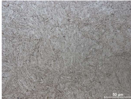
Şekil 7.2 I kalıp çeliğinin 50x objektif ile alınan 30 saniye %2 nital dağlanmış optik mikroskop görüntüsü
