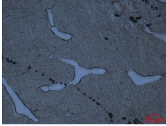
Şekil 7.11 R kalıp çeliğinin 50x objektif ile alınan 2 dakika % 3 nital ile dağlanmış metal mikroskop görüntüsü
