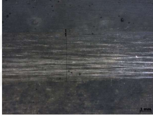
Şekil 7.40 C2-B kalıp çeliği yağsız aşınma deneyi sonrası yüzey görüntüsü (4,96 mm aşınma izi)
