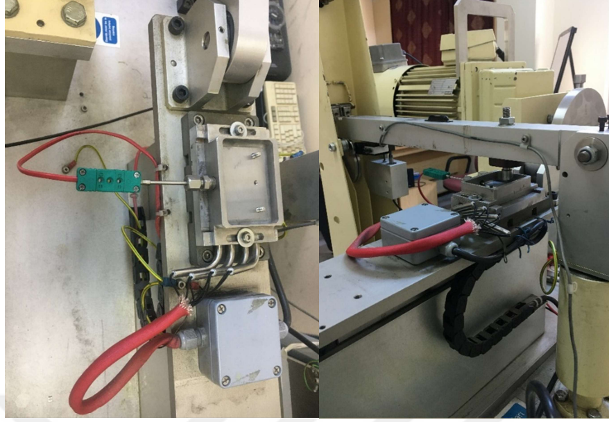
Şekil 6.10 Çelik plaka ve aşındırıcı uçların aşınma deney cihazına yerleştirilmesi (Kişisel arşiv, 2020)
