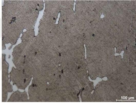
Şekil 7.12 R kalıp çeliğinin 50x objektif ile alınan 2 dakika % 3 nital ile dağlanmış optik mikroskop görüntüsü
