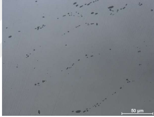
Şekil 7.10 R kalıp çeliğinin 50x objektif ile alınan 30 saniye % 2 nital ile dağlanmış optik mikroskop görüntüsü
