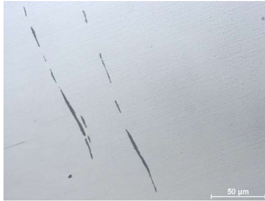
Şekil 7.14 C kalıp çeliğinin 50x objektif ile alınan 30 saniye % 2 nital ile dağlanmış optik mikroskop görüntüsü
