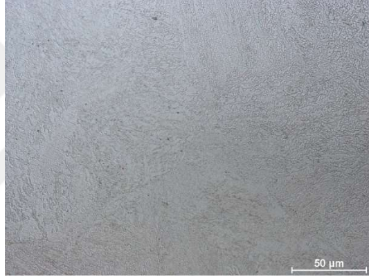
Şekil 7.6 N kalıp çeliğinin 50x objektif ile alınan 30 saniye % 2 nital ile dağlanmış optik mikroskop görüntüsü
