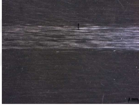
Şekil 7. 46 2311-2-B kalıp çeliği yağlı aşınma deneyi sonrası yüzey görüntüsü (2,59 mm aşınma izi)
