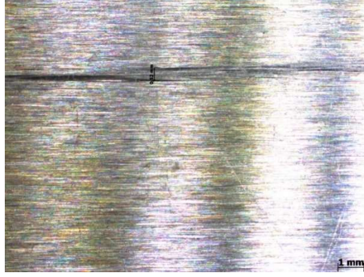
Şekil 7.39 C1 kalıp çeliği yağlı aşınma deneyi sonrası yüzey görüntüsü (0,52 mm aşınma izi)
