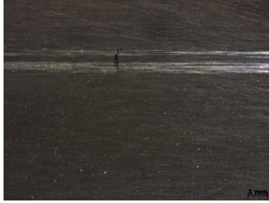
Şekil 7.45 2311-2-B kalıp çeliği yağsız aşınma deneyi sonrası yüzey görüntüsü (2,40 mm aşınma izi)
