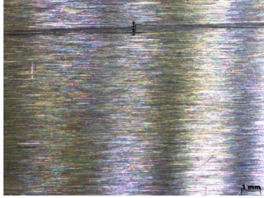
Şekil 7.33 N1 kalıp çeliği yağlı aşınma deneyi sonrası yüzey görüntüsü (0,46 mm aşınma izi)
