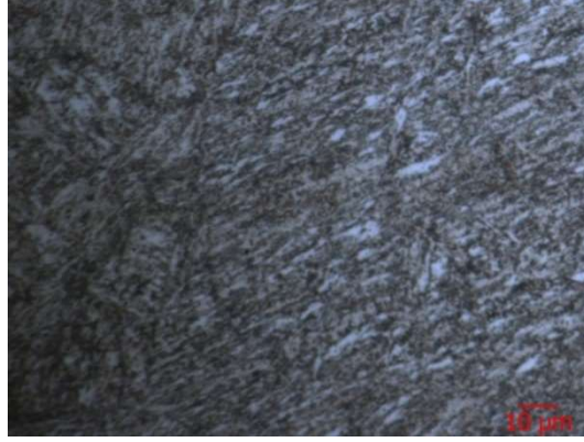
Şekil 7.3 I kalıp çeliğinin 50x objektif ile alınan 1 dakika %2 nital dağlanmış metal mikroskop görüntüsü
