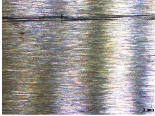
Şekil 7.30 I1 kalıp çeliği yağlı aşınma deneyi sonrası yüzey görüntüsü (0,41 mm aşınma izi)
