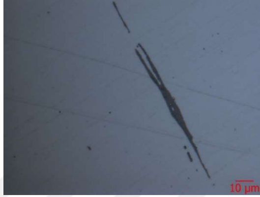
Şekil 7.13 C kalıp çeliğinin 50x objektif ile alınan 30 saniye % 2 nital ile dağlanmış metal mikroskop görüntüsü
