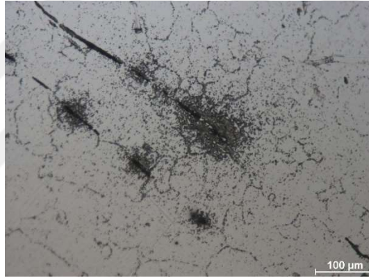
Şekil 7.16 C kalıp çeliğinin 50x objektif ile alınan 3 dakika % 3 nital ile dağlanmış optik mikroskop görüntüsü
