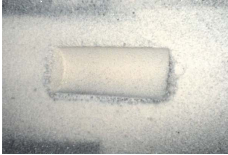
Şekil 4.19 Kaplama yapılmış kalıp.
