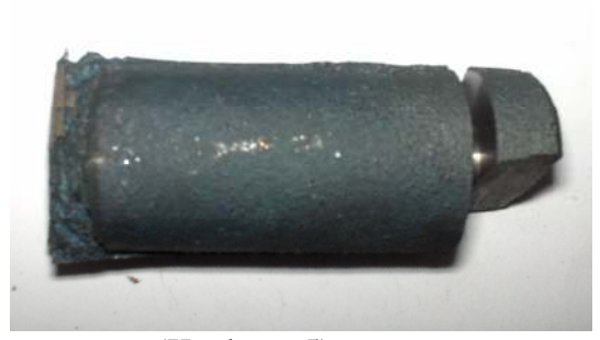
Şekil 5.32 Döküm makro görüntüsü (Kaplama 5)
