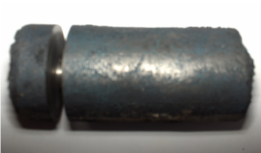
Şekil 5.31 Döküm makro görüntüsü (Kaplama 4)
