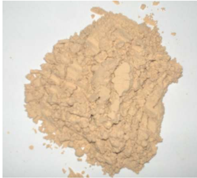
řekil 4.11 Kaplama yapımında kullanılan diatomit malzemesi
