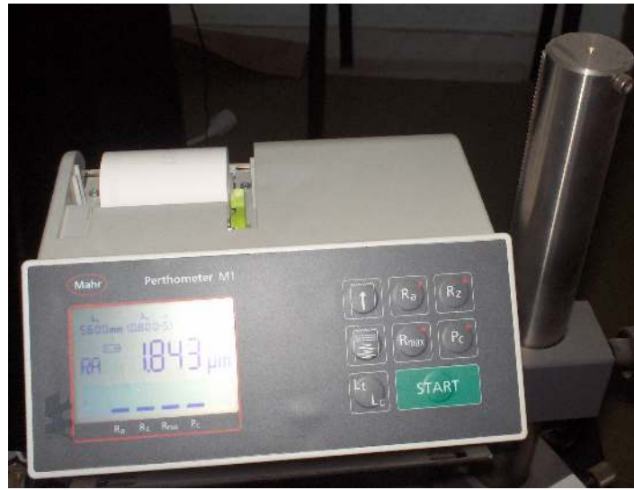
řekli 4.20 Yüzey analizlerinin gerekleřtirildiėi cihaz.
