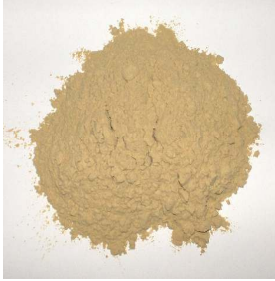
Şekil 4.10 Kaplama yapımında kullanılan bentonit malzemesi
