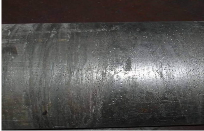
Şekil 3.6 Hatalı gömlek (gaz boşluğu + kat oluşumu).
