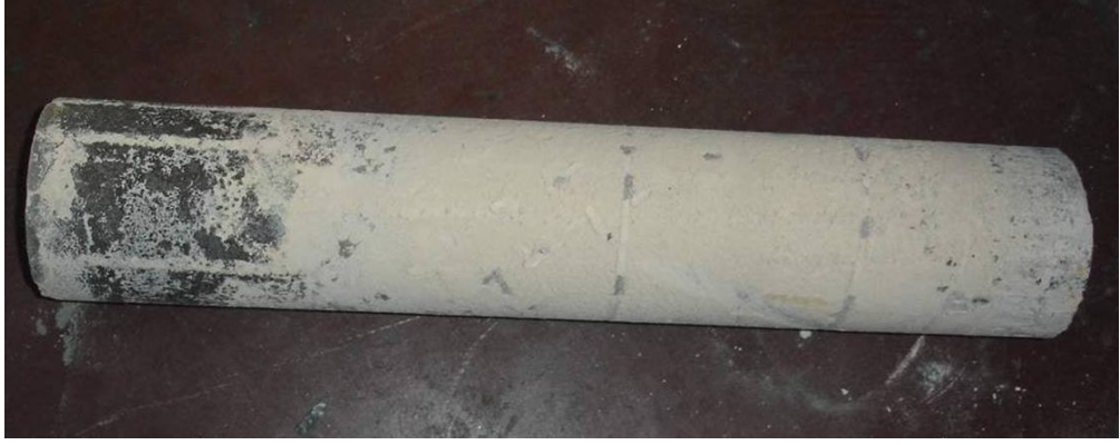
Şekil 3.5 Yetersiz kaplama uygulaması.
