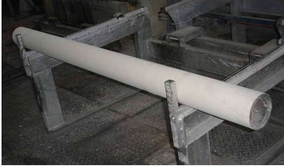
Şekil 3.7 Hatasız üretilmiş gömlek.
