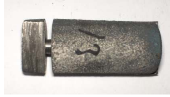
Şekil 5.36 Döküm makro görüntüsü (Kaplama 9)
