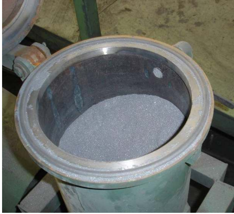
Şekil 3.4 Kuru kaplama tekniğiyle uygulanan toz kaplama malzemesi (silis unu).
