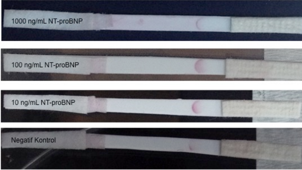
Şekil 4.30 Farklı konsantrasyonlar NT-proBNP proteini içeren ve içermeyen PBS çözeltisi ile yapılan performans denemesi.
