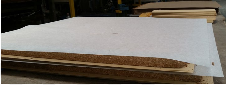
Şekil 1.7: Krep kâğıdın levha taslağına yüzeyine yerleştirmesi.
