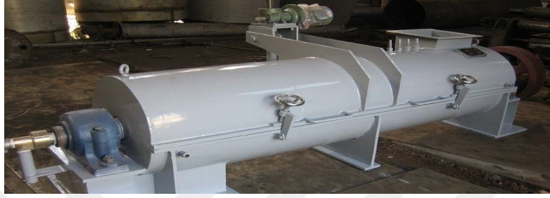
Şekil 1.4: Tutkallama makinası genel görünüşü (URL-2, 2015).
