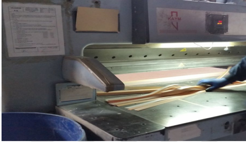
Şekil 1.9: Kâğıt kesim giyotini.
