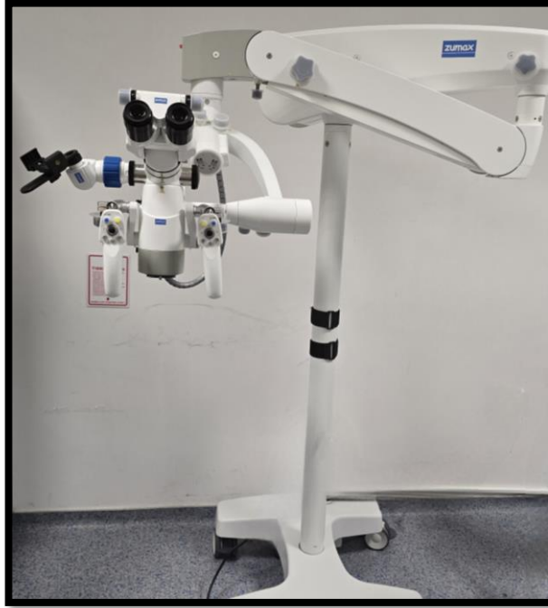
Şekil 3.3. Çalışmada kullanılan dental operasyon mikroskobu (Zuimax OM S3200, Suzhou, Çin)
