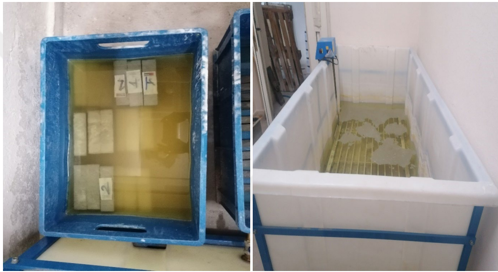
Şekil 3.6. Numunelerin küre tabi tutulması
