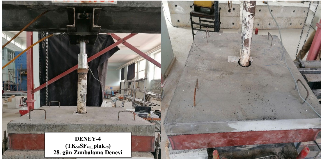
Şekil 4.26. TK 50 SF 40 _plak 28 numunesi zımbalama deneyi
