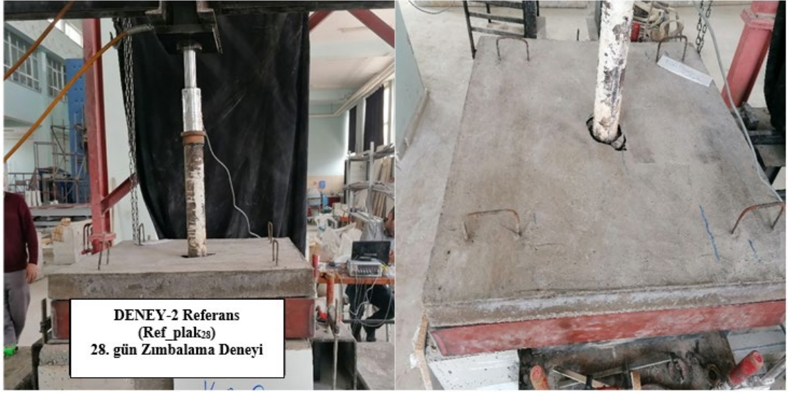
Şekil 4.16. Referans numunesi 28. gün zımbalama deneyi
