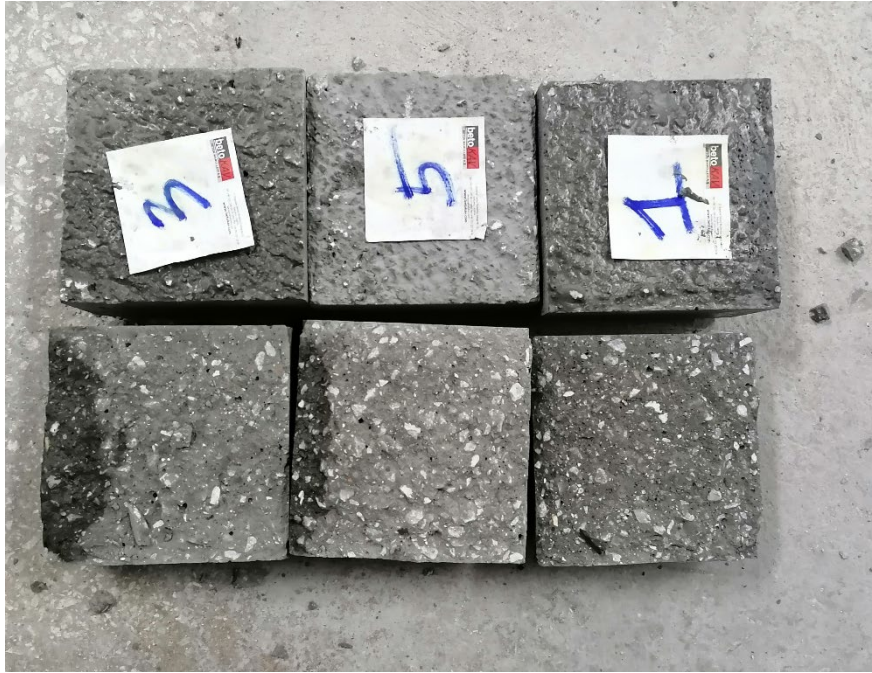
Şekil 3.10. Basınç altında su işleme derinliğinin ölçülmesi
