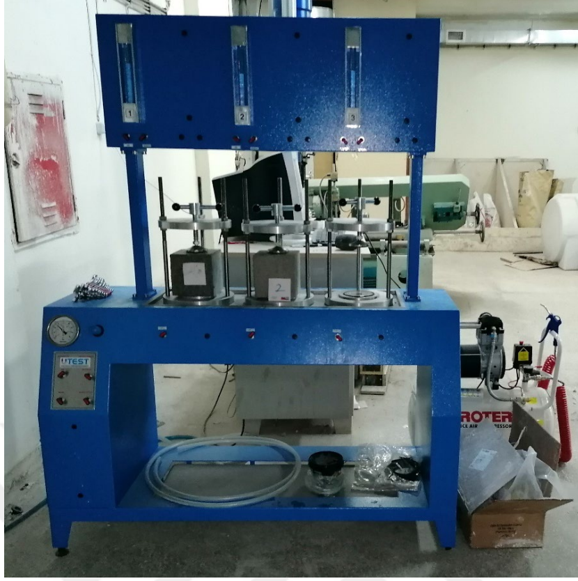
Şekil 3.30. Basınç altında su işleme derinliği tayini deneyi
