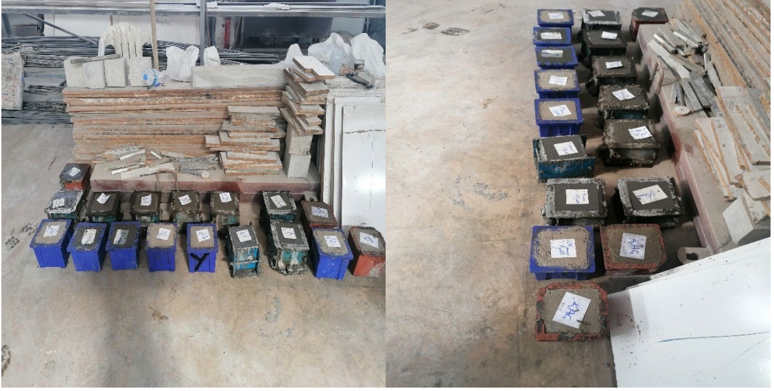
Şekil 3.21. Beton karışımlarından alınan 15x15x15 cm'lik küp numuneler
