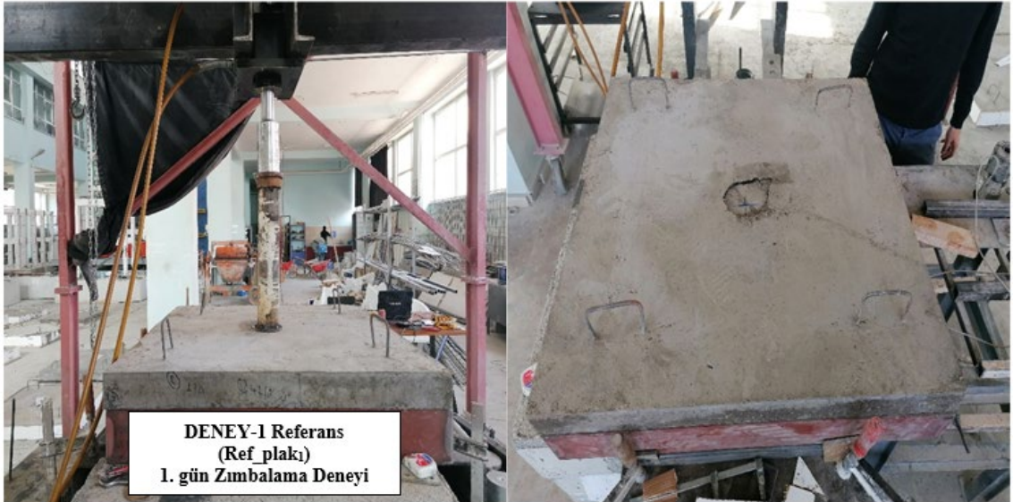
Şekil 4.10. Referans numunesi 1.gün zımbalama deneyi
