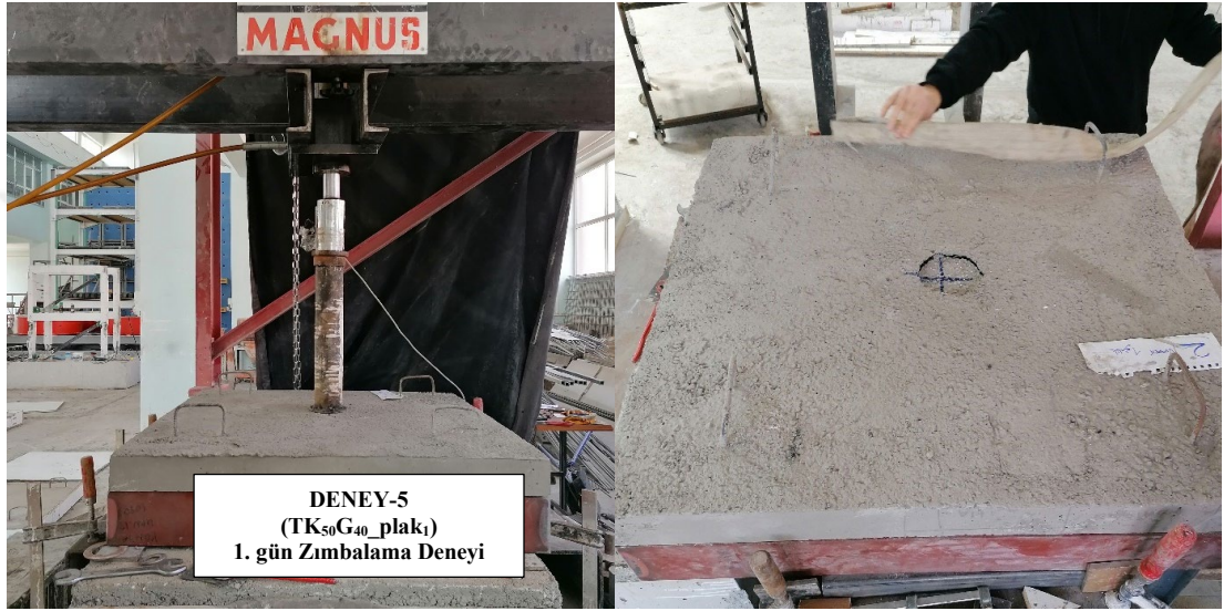
Şekil 4.31. TK 50 G 40 _plak 1 numunesi zımbalama deneyi
