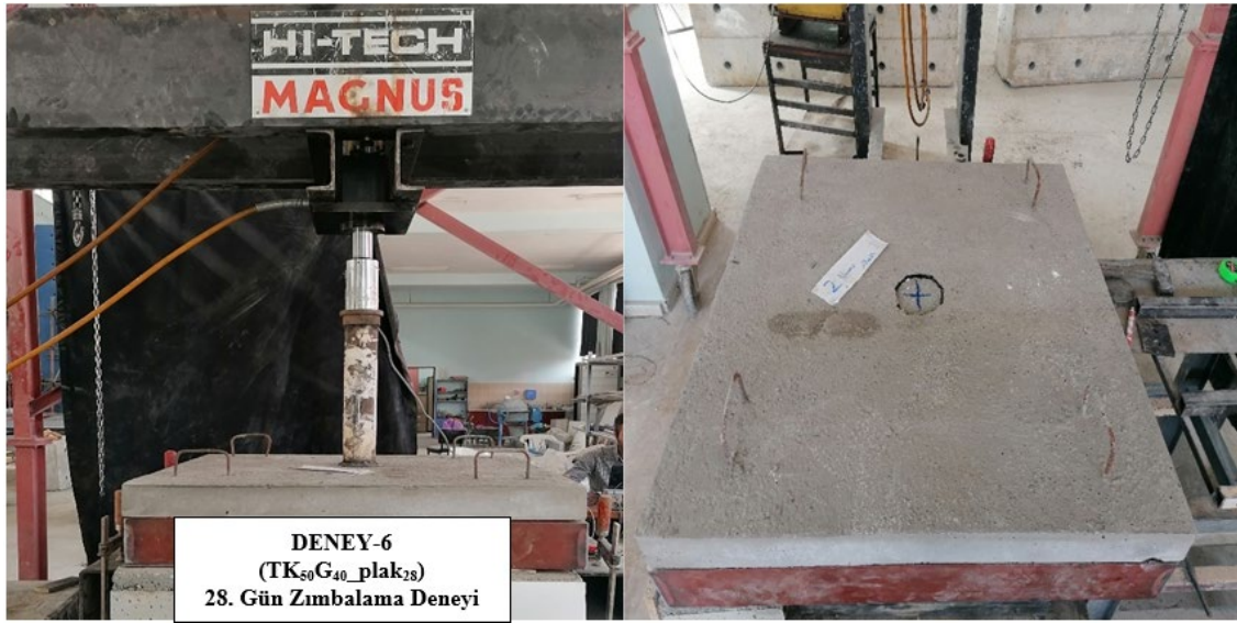
Şekil 4.36. TK 50 G 40 _plak 28 numunesi zımbalama deneyi
