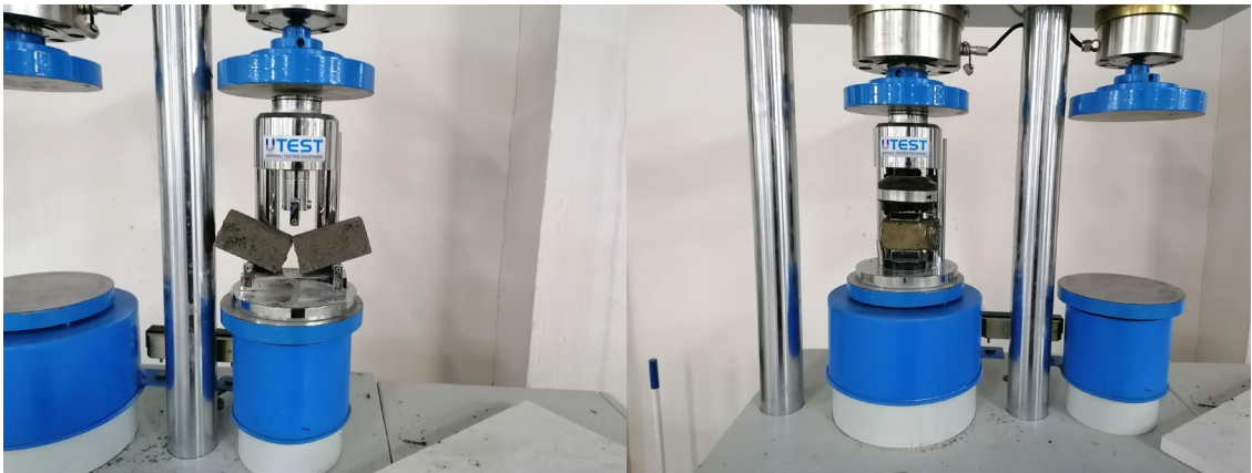
Şekil 3.7. Deneme karışımları eğilme ve basınç deneyi
