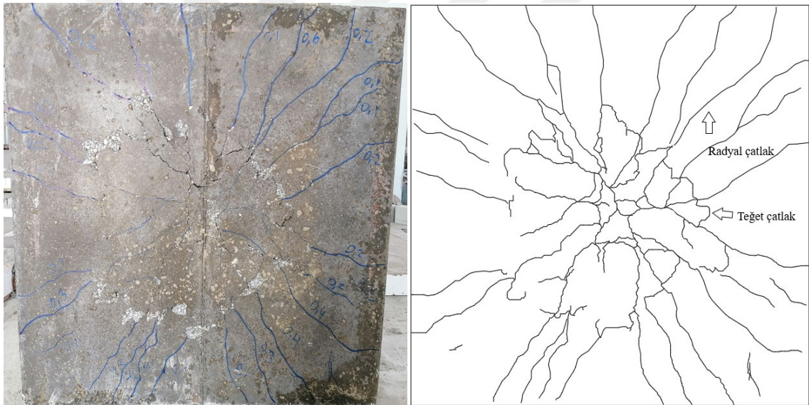
Şekil 4.12. Referans numunesi 1.gün zımbalama deney sonucu çatlak dağılımı
