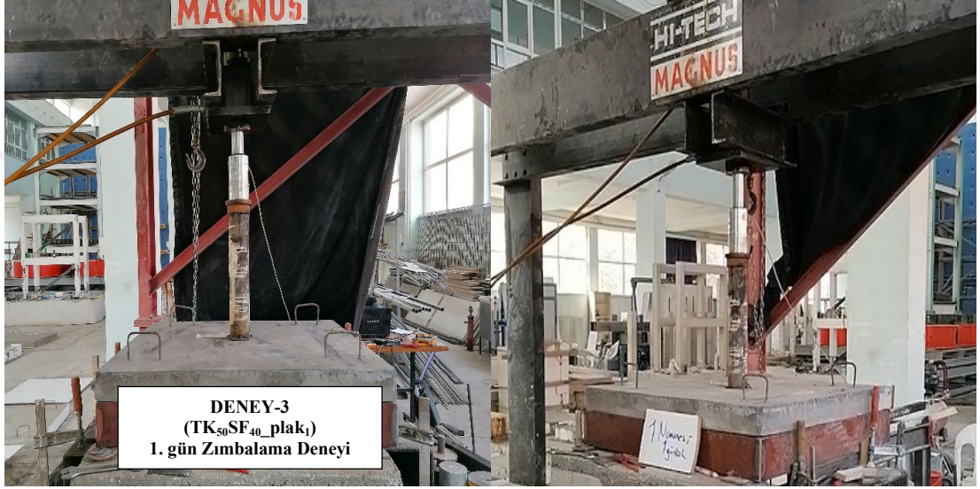
Şekil 4.21. TK 50 SF 40 _plak 1 numunesi zımbalama deneyi
