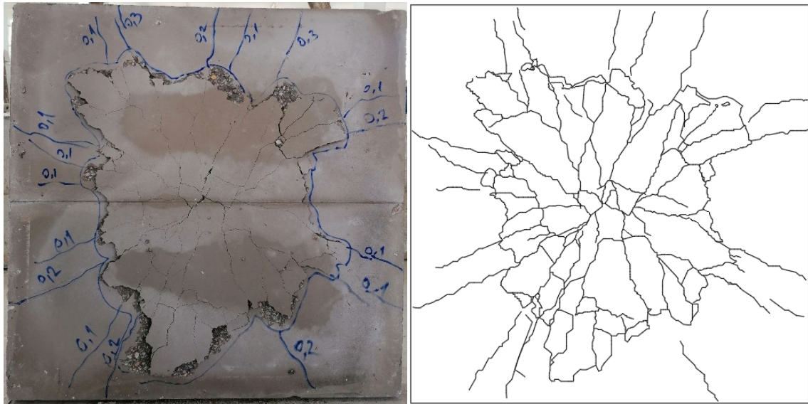
Şekil 4.37. TK 50 G 40 _plak 28 numunesi zımbalama deney sonucu çatlak dağılımı
