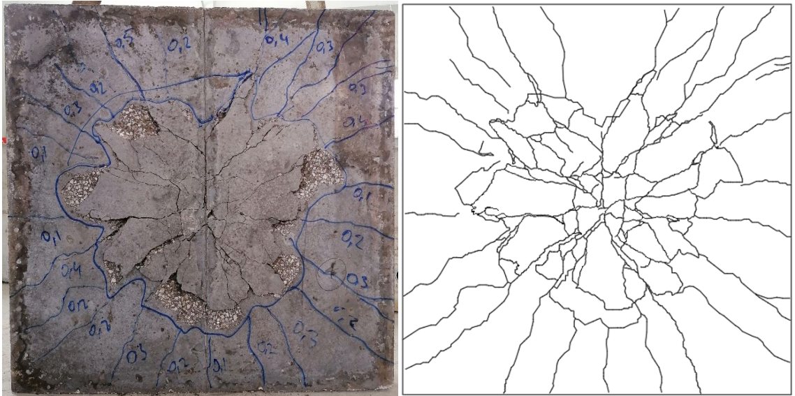
Şekil 4.17. Referans numunesi 28. gün zımbalama deney sonucu çatlak dağılımı
