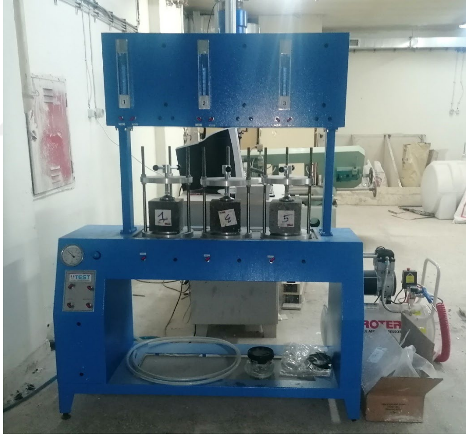
Şekil 3.8. Basınç altında su işleme derinliği tayini deneyi
