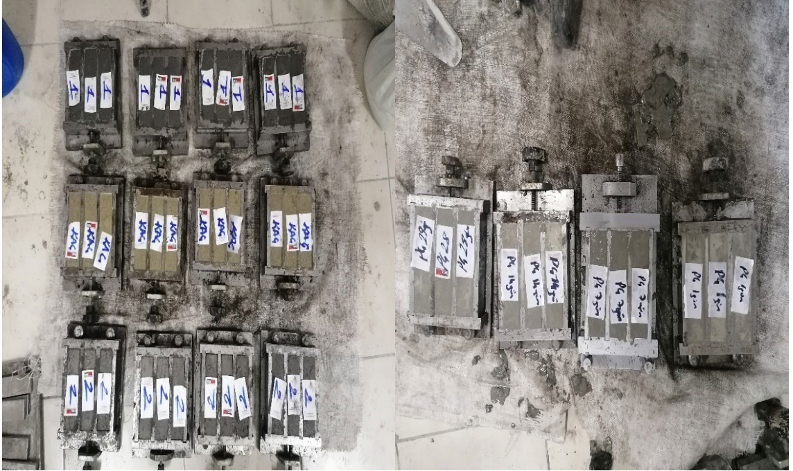
Şekil 3.13. Nihai karışım numunelerin hazırlanması
